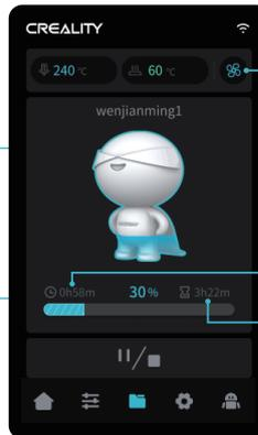
Interrupteur du ventilateur du modèle
