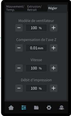
Utilisez l'interface de préparation pour régler des fonctions telles que le mouvement des axes, le contrôle de la température pour l'extrusion/la rétraction du filament et le ventilateur du modèle.
