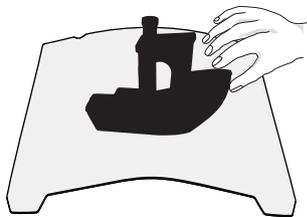
① Avec la plateforme flexible après le refroidissement du modèle imprimé Retirer de l'appareil et plier partiellement la plateforme légèrement afin de séparer le modèle de la plateforme. (Pas de pliage excessif de la plate-forme pour empêcher qu'elle ne soit déformée et inutilisable).
