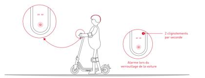
Appuyez longuement sur le bouton On/Off pendant 5 secondes pour verrouiller votre scooter, 02 l'icône de verrouillage s'affiche sur le compteur.
