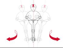
**05** Le corps doit se pencher légèrement dans la direction du virage et tourner lentement le guidon pendant le virage.
