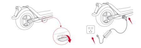
Ouvrez d'abord le cache du port de charge, branchez l'embout du câble du chargeur dans le port de charge, branchez le chargeur au courant pour charger. Une fois la charge terminée, refermez le cache du port de charge pour bonne étanchéité.
