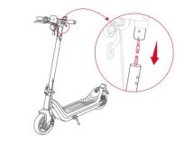
4 Visez à l'aide de la clé hexagonale fournie sur les 2 côtés (serrage : 4-5N\*ml). L'assemblage est maintenant terminé.
