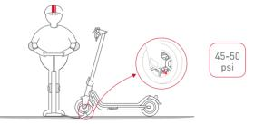
Si les pneus avant et arrière de votre trottinette sont sous-gonflés, utilisez la buse d'extension pour les gonfler. Retirez d'abord le bouchon de la buse de gonflage des pneus avant et arrière, puis serrez la buse de gonflage étendue et la buse de gonflage des pneus, puis connectez la pompe pour gonfler les pneus après les avoir serrés.
