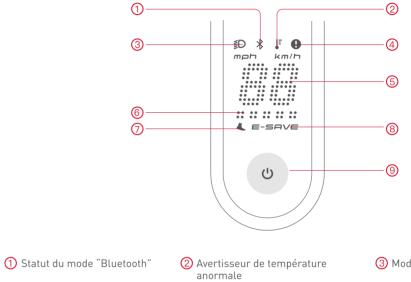
6 Affichage en temps réel de la vitesse de l'appareil et du code de défaut
