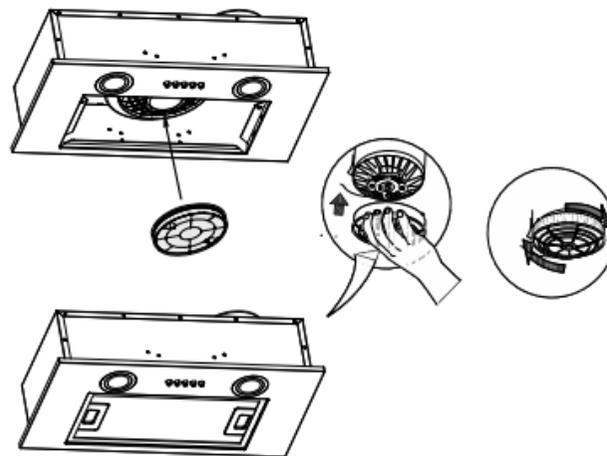
3. En cas de remplacement du filtre à charbon, veuillez tourner dans le sens anti-horaire pour détacher le filtre.
