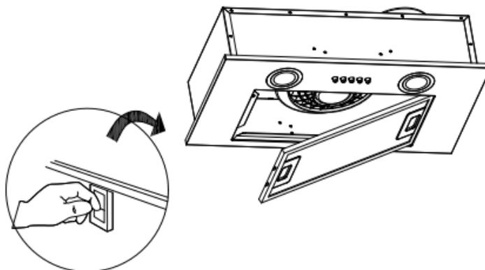
2. Installez le filtre à charbon dans l'appareil et le tourner dans le sens horaire. Répéter la même étape dans l'autre côté.
