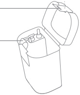
خزان المياه المتسخة
