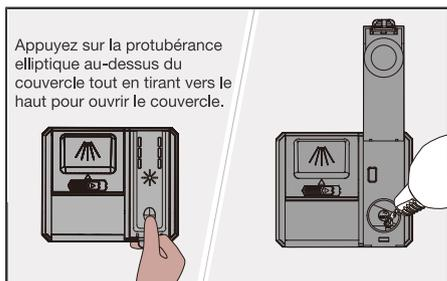
1. Ouvrez le couvercle du compartiment du liquide de rinçage.
