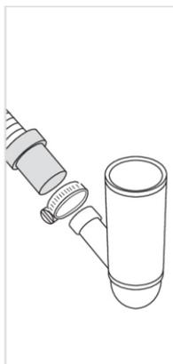
Le tuyau de vidange peut être rallongé de 3 m maximum (sa longueur totale ne doit pas excéder 4,5 m). Tous les joints et tubes de raccord doivent présenter un diamètre intérieur d'au moins 14 mm. Toutefois, le tuyau de vidange devrait, idéalement, être remplacé dans son intégralité par un nouveau tuyau sans joints.
