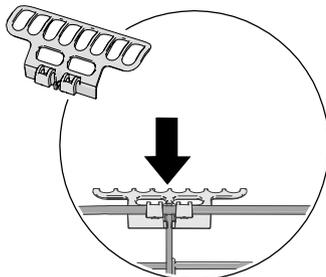
Montez le porte-couverts pour maximiser la capacité de chargement. (Il se trouve à l'intérieur du sac en plastique fourni.)
