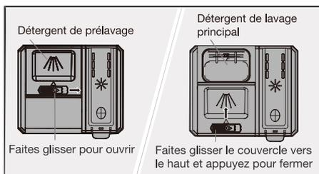
Si du détergent pour lave-vaisselle en poudre ou liquide est utilisé, ajoutez une petite quantité de détergent dans le compartiment pour détergent de pré-lavage.
