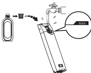
Ouvrez le bouchon du réservoir et remplissez-le d'eau du robinet jusqu'à la ligne Max. Si un nettoyage en profondeur est nécessaire, ajoutez un bouchon de flacon de solution dans le REP et fermez fermement le bouchon.
