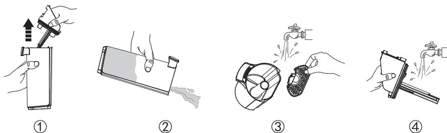
Si le couvercle du réservoir d'eau sale et le filtre à l'intérieur sont obstrués, retirez-les et rincez-les deux à l'eau.
