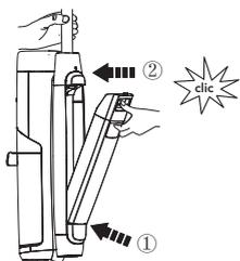
Remplacez le réservoir dans l'appareil. Vous entendrez un « clic » lorsque le réservoir est bien en place.
