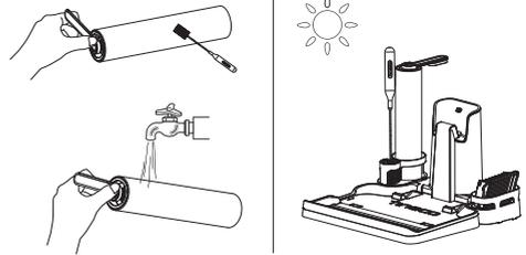
À l'aide de l'outil de nettoyage, retirez les cheveux et les débris enroulés autour du rouleau et rincez-le à l'eau. Remplacez le rouleau brosse dans le porte-accessoires et laissez-le sécher complètement avant de le réinstaller.
