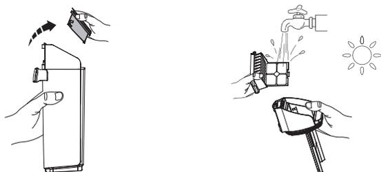
Saisissez les zones en creux de chaque côté du filtre sec et tirez vers le haut. Rincez le filtre à l'eau courante et laissez-le sécher complètement avant de le replacer entièrement sec dans le couvercle du RES.
