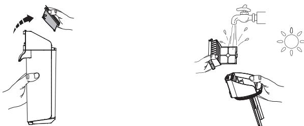
Afferrare l'area incassata su ciascun lato del filtro a secco e tirare verso l'alto. Risciacquare con acqua corrente e lasciare asciugare completamente prima di riutilizzarlo con il coperchio del serbatoio dell'acqua sporca.
