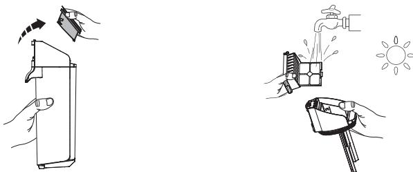
Saisissez les zones en creux de chaque côté du filtre sec et tirez vers le haut. Rincez sous l'eau courante et laissez sécher complètement avant de remplacer le filtre sec dans le couvercle du RES.
