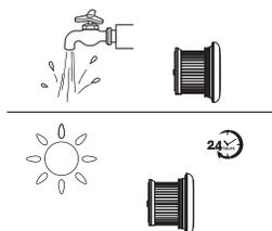
El filtro HEPA se puede lavar bajo agua corriente y debe secarse completamente antes de volver a instalarlo.
