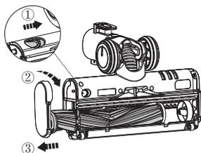
Faites glisser le bouton pour ouvrir le couvercle d'extrémité du rouleau brosse, et faites-le tourner dans le sens horaire avant de retirer le rouleau brosse.
