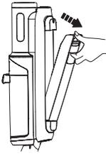
Drücken Sie die Entriegelungstaste für den Friskwasserbehälter, um ihn aus dem Gerät zu nehmen.
