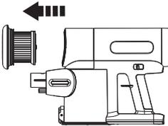
Temizlemek için HEPA filtresini (manyetik olarak tasarlanmıř) dıřarı çekin. HEPA filtresini takmadan cihazı kullanmayın.
