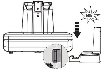
Plaats het droog- en laadstation in het stofzuigerstation zoals afgebeeld. De installatie is voltooid wanneer u een "klik" hoort.
