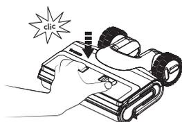
Cuando sustituya la cubierta, fijela siempre en su posición para evitar fugas.
