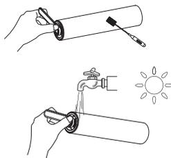
Utilice la herramienta de limpieza para eliminar el pelo y los residuos que envuelven el rodillo, aclárelo con agua y deje que se seque completamente antes de volver a instalarlo.
