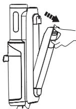
Premere il pulsante di rilascio del serbatoio dell'acqua pulita per rimuoverlo dall'apparecchio.
