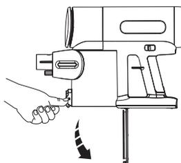
Premere il pulsante di rilascio sul lato del contenitore della polvere per svuotarne il contenuto.
