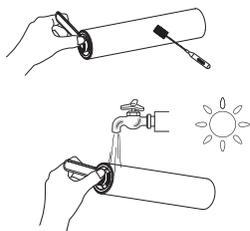
Za pomocą narzędzia czyszczącego usunąć włosy i zanieczyszczenia owinięte wokół wałka i opłukać go wodą, po czym pozostawić do całkowitego wyschnięcia przed ponownym zamontowaniem.
