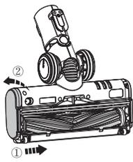
Setzen Sie die Bürstenrolle wieder vollständig in die Bürstenöffnung ein und drehen Sie die Endkappe gegen den Uhrzeigersinn, bis sie wieder sicher einrastet.
