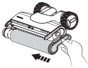
Wymienić walek szczotki, wsuwając jej koniec do uchwytu po lewej stronie, a następnie mocując zakładkę rolki do magnetycznego zapięcia po prawej stronie, by zamocować w miejscu.
