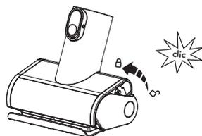
Vuelva a insertar completamente el cepillo de rodillo inclinado y presione hacia arriba hasta que quede encajado de forma segura.
