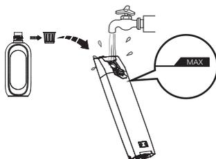
Aprire il coperchio del serbatoio e riempire il serbatoio con acqua corrente fino alla linea MAX. Quando è necessaria una pulizia approfondita, aggiungere un tappo del flacone della soluzione nel serbatoio dell'acqua pulita e chiudere saldamente il coperchio.
