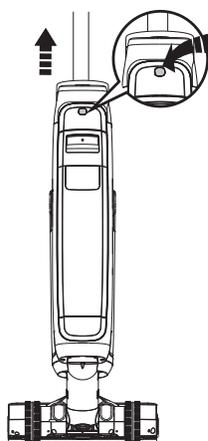
Aby usunąć uchwyt, nacisnąć przycisk odłączania z tyłu urządzenia, a następnie pociągnąć uchwyt w górę.
