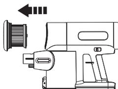
Wyciągnąć filtr HEPA (magnetyczny) do czyszczenia. Nie używać urządzenia, w którym nie ma filtra HEPA.
