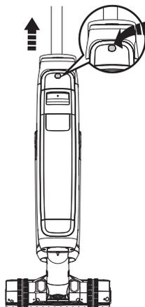
Om de handgreep te verwijderen, drukt u op de ontgrendelknop aan de achterkant van het apparaat en trekt u de handgreep omhoog.
