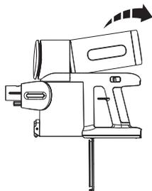
Retirez l'outil de dépose de l'ensemble multicône.
