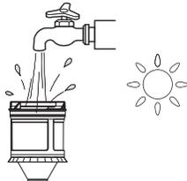
Reinigen Sie den Filter und trocknen Sie ihn vollständig, bevor Sie ihn wieder einsetzen.
