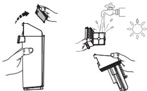
Chwycić filtr suchy za wgłębienia po obu stronach i pociągnąć do góry. Wyflukać pod bieżącą wodą i pozostawić do całkowitego wyschnięcia przed umieszczeniem w pokrywie zbiornika na brudną wodę.
