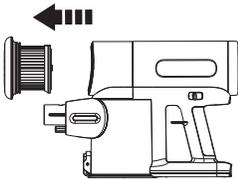
Ziehen Sie den HEPA-Filter (magnetische Ausführung) zur Reinigung heraus. Nehmen Sie das Gerät nicht ohne zuvor eingesetzten HEPA-Filter in Betrieb.
