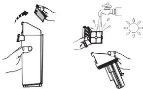
Sujete la zona rebajada de cada lado del filtro seco y tire hacia arriba. Enjuáguelo bajo el grifo y asegúrese de que está completamente seco antes de volver a combinarlo con la tapa del DAS.
