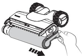
Wyjąć walek szczotki, chwytając go za wypustkę i wyciągając.
