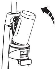
Om te installeren plaatst u de SwitchPro Motor in de vloerwasser, duwt u hem naar binnen en is de installatie voltooid wanneer u een klik hoort.
