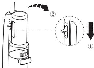
Aby usunąć SwitchPro Motor, przytrzymać urządzenie jedną ręką, a drugą nacisnąć suwak odłączania.
