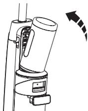
Para instalarlo, inserte el SwitchPro Motor en la lavadora de suelo, empújelo, la instalación estará completa cuando oiga un clic.
