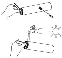
Utilizzare lo strumento di pulizia per rimuovere peli e detriti avvolti attorno al rullo, sciacquare il rullo con acqua e lasciarlo asciugare completamente prima di reinstallarlo.
