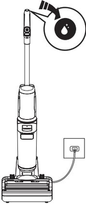
1. Kullanımdan sonra cihazı şarj ünitesine yerleştirin, sensör kir seviyesini otomatik olarak algılayacaktır.
