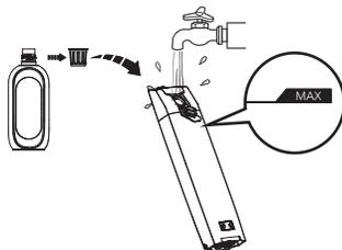
Open de tankdop en vul vervolgens de tank met kraanwater tot aan de Max-lijn. Als een grondige reiniging nodig is, voegt u een flesdop met oplossing toe aan de CWT en sluit u de dop goed af.
