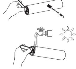
Silindirin etrafına dolanan saçları ve kalıntıları temizlemek için temizleme aletini kullanarak silindiri suyla durulayın ve yeniden takmadan önce tamamen kurumasını bekleyin.
