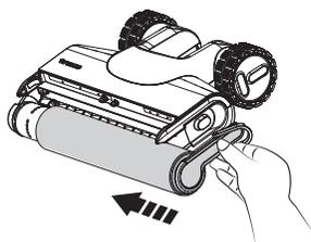
Sostituire il rullo della spazzola inserendone l'estremità nel lato sinistro del supporto, quindi attaccare la linguetta del rullo alla fibbia magnetica sul lato destro per bloccarlo in posizione.
