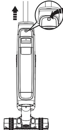
Kulpu çıkarmak için, cihazın arkasındaki serbest bırakma düğmesine basın ve kulpu yukarı doğru çekin.
