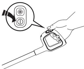
Appuyez sur le bouton ① pour que l'appareil démarre en mode AUTO par défaut. Appuyez à nouveau sur ce bouton pour éteindre l'appareil. Alternez entre les modes AUTO, MAX et SUCTION en appuyant sur le bouton
