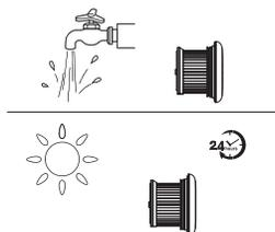
Filtr HEPA można umyć pod bieżącą wodą. Przed ponownym montażem należy go całkowicie wysuszyć.
