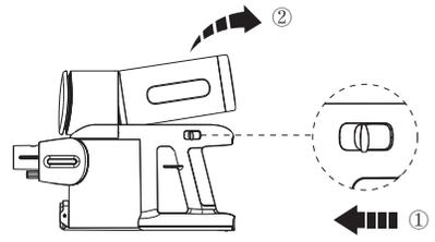
SwitchPro Motoru çıkarmak için bir elinizle cihazı tutun, diğer elinizle çıkarma sürgüsüne basın.
