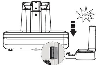
Setzen Sie das Trocknungs- und Ladedock wie abgebildet in das Staubsaugerdock ein. Die Installation ist abgeschlossen, wenn das Dock hörbar einrastet.
