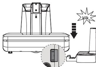
Wsuń suszącą i ładującą stację dokowania w stację dokowania odkurzacza, jak pokazano na ilustracji. Montaż jest zakończony, jeśli rozlegnie się kliknięcie.
