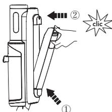
Remplacez le réservoir dans l'appareil. Vous entendrez un « clic » lorsque le réservoir est bien en place.
