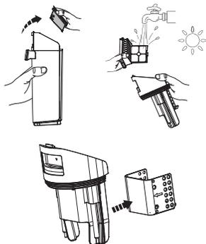
Saisissez les zones en creux de chaque côté du filtre sec et tirez vers le haut. Rincez sous l'eau courante et laissez sécher complètement avant de replacer le filtre sec dans le couvercle du RES.
