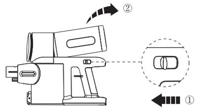
Om de SwitchPro Motor te verwijderen, houdt u het apparaat met één hand vast en drukt u met de andere hand op de vrijgaveknop.
