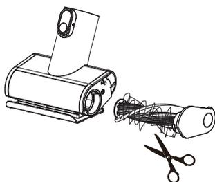
Usunąć zanieczyszczenia owinięte wokół wałka za pomocą narzędzia do czyszczenia.
