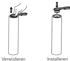
Trek de rolhendel omhoog om hem te verwijderen. Nadat u de borstelrol heeft verwijderd, installeert u het handvat in de nieuwe borstelrol.
