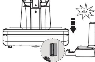
Inserte la base de secado y carga en la base de aspiración como se muestra. La instalación estará completa cuando se escuche un chasquido.
