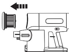
Estire del filtro HEPA (de diseño magnético) para limpiarlo. No utilice el aparato sin instalar primero el filtro HEPA.
