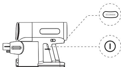
Nacisnąć przycisk (I). Urządzenie domyślnie uruchomi się w trybie ECO. Nacisnąć ponownie, aby wyłączyć urządzenie. Przełączenie pomiędzy trybem ECO i MAX następuje po naciśnięciu przycisku (ECO/MAX).
