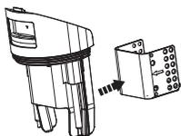
Separator odpadów można usunąć i wyflukać pod bieżącą wodą.
