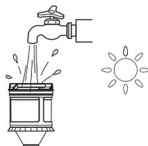
Limpie el filtro y séquelo completamente antes de volver a instalarlo.
