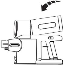
Takmak için, SwitchPro Motoru elektrikli süpürge için içine sokun, içeri doğru itin, tık sesi duyduğunuzda takma işlemi tamamlanmıştır.
