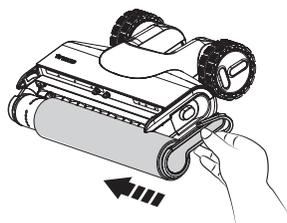
Remettez le rouleau brosse en place en insérant son extrémité dans le côté gauche du support, puis fixez la languette du rouleau à la boucle magnétique à droite pour la verrouiller en place.
