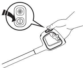
Druk op de knop ① en het apparaat start standaard in de AUTO-modus. Druk nogmaals om het apparaat uit te schakelen. Schakel tussen de AUTO- en MAX- en SUCTION-modus door op de knop
