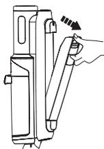
Pulse el botón de liberación del depósito de agua limpia para sacarlo del aparato.
