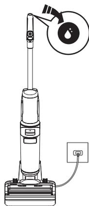
1. Coloque el aparato en la base de carga después de utilizarlo, el sensor detectará automáticamente el nivel de suciedad.
