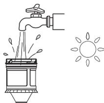
Reinig het filter en droog het volledig voordat u het opnieuw installeert.
