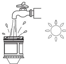
Nettoyez le filtre et séchez-le complètement avant de le réinstaller.
