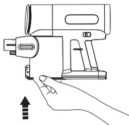
Appuyez sur le bouton de déverrouillage situé sur le côté du bac à poussière et videz le contenu.
