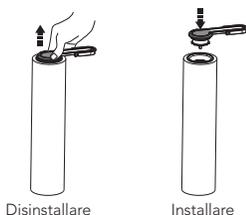
Premere l'impugnatura del rullo per rimuoverlo. Una volta rimosso, installare l'impugnatura nel nuovo rullo della spazzola.
