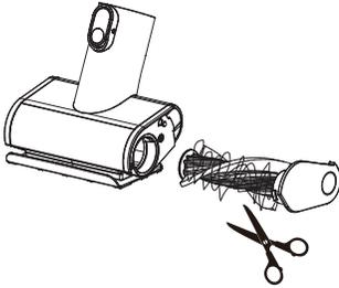
Silindirin etrafına sarı kalıntıları temizleme aletiyle çıkarın.
