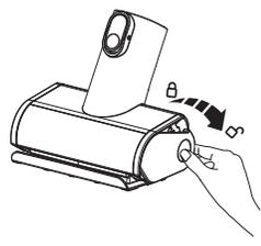
Presione la cubierta del rodillo final hacia abajo.
