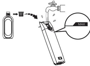
Öffnen Sie den Tankdeckel und füllen Sie den Behälter bis zur Max-Linie mit Leitungswasser. Wenn eine gründliche Reinigung erforderlich ist, fügen Sie dem FWB einen Flaschenschluss der Lösung hinzu, und schließen Sie den Verschluss fest.
