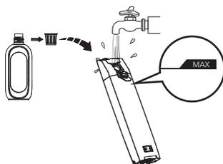
Otworzyć korek zbiornika, a następnie napełnić zbiornik wodą z kranu do poziomu linii Max. Gdy konieczne jest gruntowne czyszczenie, dodać jedną nakrętkę środka czyszczącego do ZCW i dokładnie zamknąć korek.
