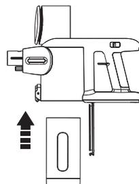
Inserire lo strumento di rimozione del gruppo multicono verso l'alto nel contenitore della polvere.
