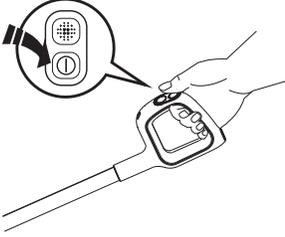
① düğmesine basın, cihaz varsayılan olarak AUTO modda başlayacaktır. Cihazı kapatmak için tekrar basınız.
