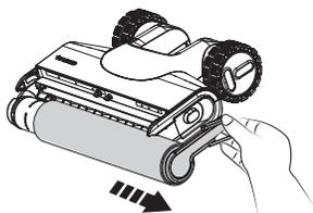
Verwijder de borstelrol door het lipje van de borstelrol vast te pakken en eruit te trekken.
