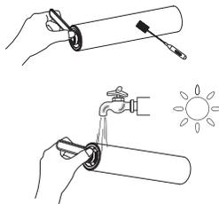
Verwenden Sie das Reinigungswerkzeug, um die Haare und Verunreinigungen zu entfernen, die sich um die Rolle gewickelt haben, spülen Sie die Rolle mit Wasser ab und lassen Sie sie vor dem Wiedereinbau vollständig trocknen.
