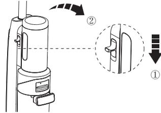
Um den SwitchPro Motor zu entfernen, halten Sie das Gerät mit einer Hand fest und drücken Sie mit der anderen Hand die Entriegelung.
