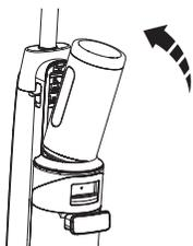
Aby zamontować, włożyć SwitchPro Motor do myjki do podłogi i wcisnąć do środka. Montaż jest zakończony, gdy rozlegnie się kliknięcie.
