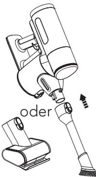
Verbinden Sie das Zubehörwerkzeug mit dem Gerät.
