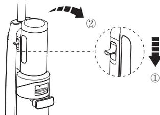
Para retirar el SwitchPro Motor, sujete el aparato con una mano y presione el deslizador de liberación con la otra.
