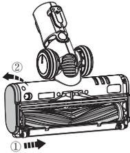
Vuelva a insertar completamente el cepillo de rodillo en la ventana del cepillo y podrá girar la cubierta en el sentido antihorario hasta que encaje de forma segura.
