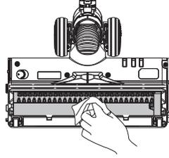
Fırça silindiri uç kapağını açmak için düğmeyi kaydırın ve fırça silindiri dışarı çekmeden önce saat yönünde çevirin.
