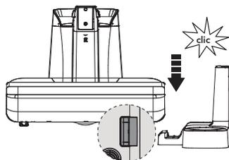
Inserire la base di asciugatura e ricarica nella base dell'aspirapolvere come mostrato. L'installazione è completa quando si sente un "clic".
