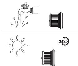
Het HEPA filter kan onder stromend water worden gewassen en moet volledig droog zijn voordat het weer wordt geïnstalleerd.
