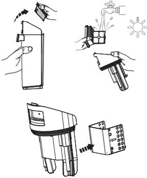
Pak het verzonken gedeelte aan elke kant van het droogfilter vast en trek het omhoog. Spoel af onder stromend water en moet volledig droog zijn alvorens opnieuw te combineren met het deksel van de DWT.
