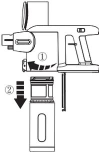
Drehen Sie ihn, um den Maschenfilter zu entfernen.
