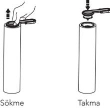
Çıkarmak için silindir kolunu yukarı çekin. Silindiri çıkardıktan sonra kolu, yeni fırça silindirine takın.
