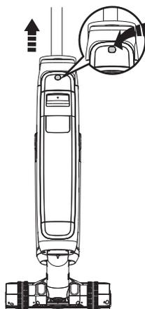
Para retirar el asa, pulse el botón de desbloqueo situado en la parte posterior del aparato y, a continuación, tire del asa hacia arriba.
