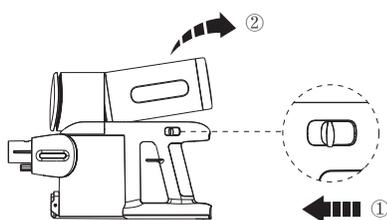
Para retirar el SwitchPro Motor, sujete el aparato con una mano y presione el deslizador de liberación con la otra.
