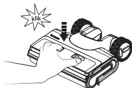
Zakładając pokrywę, należy ją zatrzasać, aby zapobiec wyciekom.
