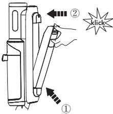
Setzen Sie den Behälter wieder in das Gerät ein. Wenn Sie den Vorgang korrekt ausgeführt haben, sollten Sie ein „klick“ hören.
