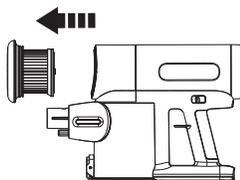
Retirez le filtre HEPA (de conception magnétique) pour le nettoyage. N'utilisez pas l'appareil sans avoir préalablement installé le filtre HEPA.
