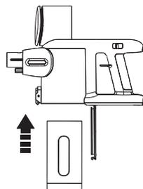
Steek het gereedschap voor het verwijderen van de multicone-samenstelling omhoog in de stofbak.
