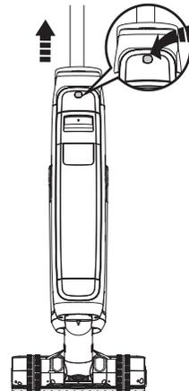
Um den Griff zu entfernen, drücken Sie den Entriegelungsknopf auf der Rückseite des Geräts und ziehen Sie den Griff nach oben.
