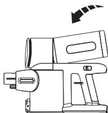
Aby zamontować, włożyć SwitchPro Motor do odkurzacza i wcisnąć do środka. Montaż jest zakończony, gdy rozlegnie się kliknięcie.
