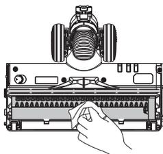
Przesunąć przełącznik, aby otworzyć pokrywę wałka szczotki. Obracać szczotkę w kierunku zgodnym z ruchem wskazówek zegara przed jego wyjęciem.
