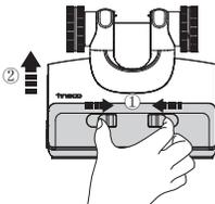
Drücken Sie die Verriegelung der Abdeckung zusammen und ziehen Sie die Abdeckung zum Entfernen nach oben.
