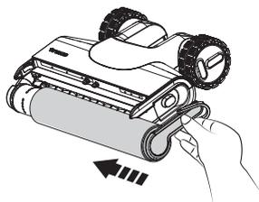
Para volver a colocar el cepillo de rodillo, inserte el extremo izquierdo del asa y, a continuación, acople la pestaña del rodillo a la hebilla magnética del lado derecho para bloquearla.
