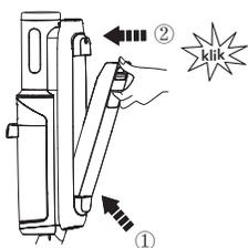
Plaats de tank terug in het apparaat. U zou een "klik" moeten horen als dit correct is gedaan.
