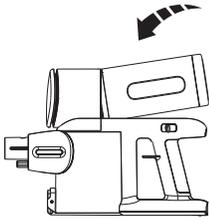
Zum Einbau setzen Sie den SwitchPro Motor in den Staubsauger ein und drücken ihn an. Der Einbau ist abgeschlossen, wenn er hörbar einrastet.
