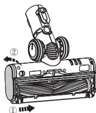
Całkowicie umieścić wałek szczotki w okienku szczotki i obrócić pokrywę znajdującą się na końcu wałka w lewo, aby wałek zatrzasknął się na miejscu.
