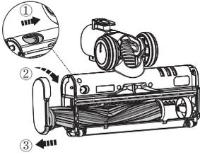
Deslice el interruptor para abrir la cubierta del cepillo de rodillo y gírela en sentido horario para retirar el cepillo de rodillo.
