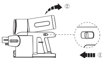
Aby usunąć SwitchPro Motor, przytrzymać urządzenie jedną ręką, a drugą nacisnąć suwak odłączania.
