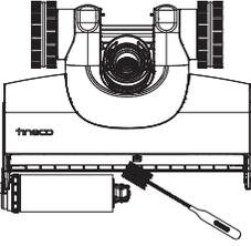
Fırça silindiri bölmesindeki ve açıklıktaki saçları ve birikintileri temizleme aletiyle temizleyin.
