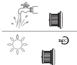
Le filtre HEPA peut être lavé à l'eau courante et doit être séché complètement avant d'être réinstallé.
