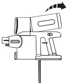
Neem het gereedschap voor het verwijderen van de multicone-samenstelling.
