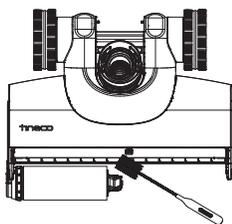
Elimine el pelo y la suciedad de la cámara del cepillo de rodillo y de la abertura con una herramienta de limpieza.
