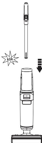
Om de handgreep te monteren, steekt u deze in het apparaat totdat u een klik hoort.
