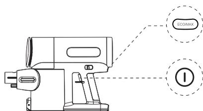
Appuyez sur le bouton ① pour que l'appareil démarre en mode ECO par défaut. Appuyez à nouveau sur ce bouton pour éteindre l'appareil. Passez du mode ECO au mode MAX en appuyant sur le bouton **ECONOMAX**.
