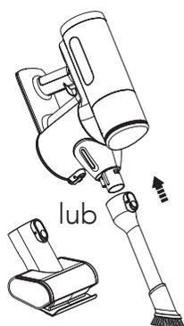
Podłączyć akcesorium do urządzenia głównego.
