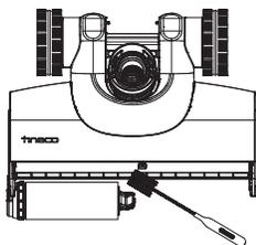
Za pomocą narzędzia do czyszczenia usunąć włosy i odpadki z komory wałka szczotki oraz otworu.
