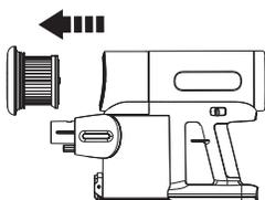
Trek het HEPA filter (in magnetische uitvoering) eruit om te reinigen. Gebruik het apparaat niet zonder eerst het HEPA filter te hebben geïnstalleerd.
