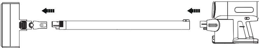
Verbinden Sie Bürste, Saugrohr und Gerät wie oben gezeigt.
