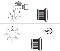
Der HEPA-Filter kann bei Bedarf unter fließendem Wasser gereinigt werden. Er muss vor dem Einsetzen vollständig trocken sein.
