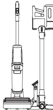
Coloque el aparato y los accesorios en la base de la aspiradora para almacenarlo de forma cómoda después de usarlo.
