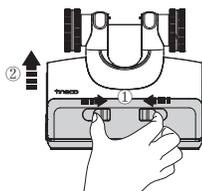
Ścisnąć zatrzaski na pokrywie i pociągnąć do góry, aby wyjąć.
