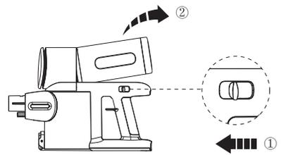
Um den SwitchPro Motor zu entfernen, halten Sie das Gerät mit einer Hand fest und drücken Sie mit der anderen Hand die Entriegelung.
