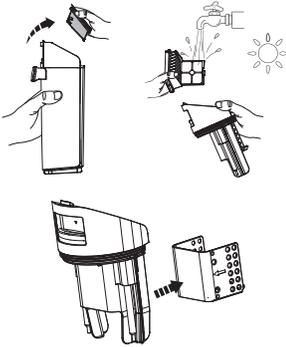
Fassen Sie den vertieften Bereich auf jeder Seite des Trockenfilters und ziehen Sie ihn nach oben. Spülen Sie ihn unter fließendem Wasser ab. Der Filter muss vollständig trocken sein, bevor Sie ihn wieder in den Deckel des SWB einsetzen.
