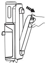
Druk op de ontgrendelingsknop van de schoonwatertank om de CWT van het apparaat te verwijderen.
