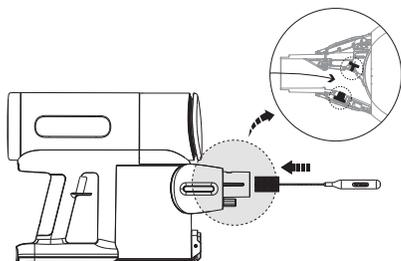
Aby zapobiec gromadzeniu się kurzu, który może obniżyć skuteczność odkurzacza, wytrzeć dyszę ssącą narzędziem do czyszczenia.
