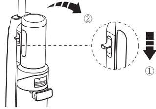
SwitchPro Motoru çıkarmak için bir elinizle cihazı tutun, diğer elinizle çıkarma sürgüsüne basın.
