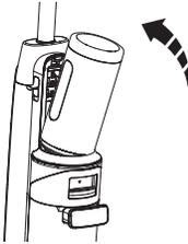
Zum Einbau setzen Sie den SwitchPro Motor in den Bodenwäscher ein und drücken ihn an. Der Einbau ist abgeschlossen, wenn er hörbar einrastet.
