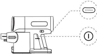
① düğmesine basın, cihaz varsayılan olarak ECO moda başlayacaktır. Cihazı kapatmak için tekrar basınız. (ECONOMAX) düğmesine basarak ECO (Otomatik) ve MAX (Maks.) modu arasında geçiş yapın.
