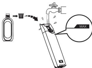
Abra el tapón del depósito y llénelo con agua del grifo hasta la línea de nivel máximo. Cuando sea necesario realizar una limpieza a fondo, añada un tapón de solución al DAL y cierre bien el tapón.
