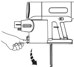
Drücken Sie die Entriegelungstaste an der Seite des Staubbehälters, um den Inhalt zu entleeren.
