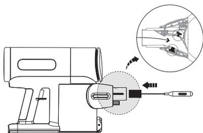
Per evitare l'accumulo di polvere che può influire sulle prestazioni di pulizia, pulire la bocchetta di aspirazione con lo strumento di pulizia.
