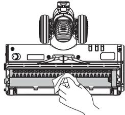
Schieben Sie den Schalter, um die Abdeckung der Bürstenrolle zu öffnen, und drehen Sie sie im Uhrzeigersinn, bevor Sie die Bürstenrolle herausziehen.
