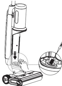
Reinigen Sie den Schmutzsensord mit einem feuchten Tuch oder dem Reinigungswerkzeug.
