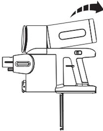
Nehmen Sie das Werkzeug zum Entfernen der Multikonus-Baugruppe heraus.
