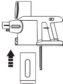
Führen Sie das Werkzeug zum Entfernen der Multikonus-Baugruppe nach oben in den Mülleimer ein.
