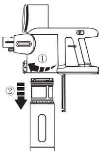
Draai om het gaasfilter te verwijderen.
