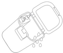
2. Spoel de vuilwatertank uit met schoon water, en gebruik het bijgeleverde schoonmaakgereedschap om de binnenwand van de vuilwatertank schoon te maken.
