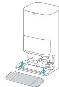
**3. Entfernen Sie die Schutzvorrichtungen des Roboters und installieren Sie die Seitenbürste und die Mopp-Baugruppe**
