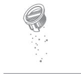
2. Sollte der Filter verschmutzt sein und eine Reinigung erfordern, spülen Sie ihn mit Wasser ab. Vor der Wiederverwendung muss er vollständig trocken sein.
