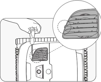
2. Après avoir retiré le cache du système d'évacuation, retirez le cache de l'hélice afin d'exposer l'hélice.
