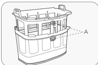
Assurez-vous que les points A du panier du filtre sont alignés avec A sur le filtre ultra fin MicroMesh™ remplaçable.
