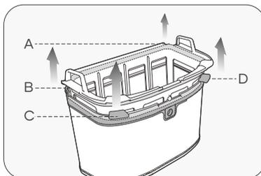
Relevez les quatre coins A, B, C et D de la bande en caoutchouc à tour de rôle. Assurez-vous qu'ils sont coincés dans la rainure à loquet du filtre ultra fin MicroMesh™ remplaçable.
