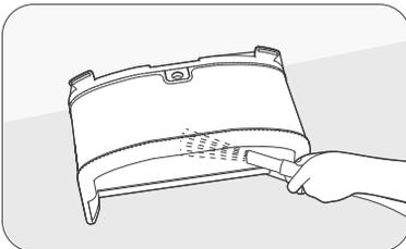
Vous devez rincer l'intérieur ainsi que l'extérieur du filtre ultra fin MicroMesh™ remplaçable. Frottez manuellement si nécessaire.
