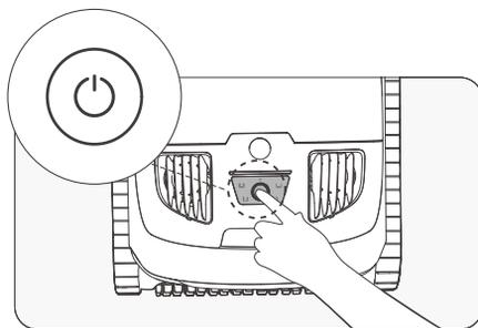
2. Appuyez brièvement sur le bouton
