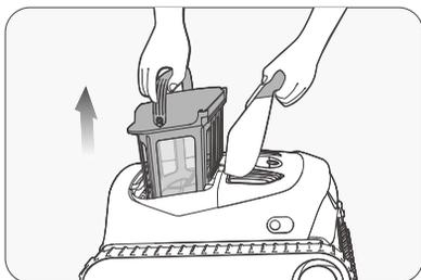
3. Appuyez sur le loquet du panier de filtre et soulevez la poignée du cache supérieur pour ouvrir ce dernier.
