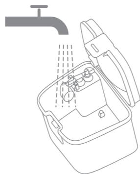
**Obs:** Flottörkulan i smutsvattentanken är en rörlig del. Använd inte för mycket kraft när du rengör den för att undvika att skada den.
