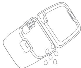
2. Spoel de vuilwatertank uit met schoon water, en gebruik het juiste schoonmaakgereedschap om de binnenwand van de vuilwatertank schoon te maken.
