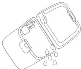
2. Enjuague el depósito de agua usada con agua limpia, y utilice la herramienta de limpieza adecuada para limpiar la pared interior del depósito de agua usada.
