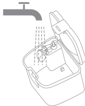
**Nota:** a bola flutuante no depósito de água usada é uma peça móvel. Não aplique demasiada força ao limpá-lo para não o danificar.
