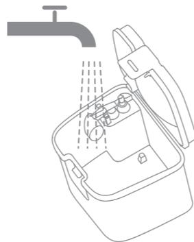
**Nota:** La sfera del galleggiante nel serbatoio dell'acqua usata è una parte mobile. Non applicare troppa forza durante la pulizia per evitare di danneggiarla.
