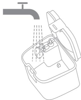
**Remarque :** La boule flottante dans le réservoir d'eau sale est une pièce mobile. N'appliquez pas une force excessive lorsque vous la nettoyez pour ne pas l'endommager.
