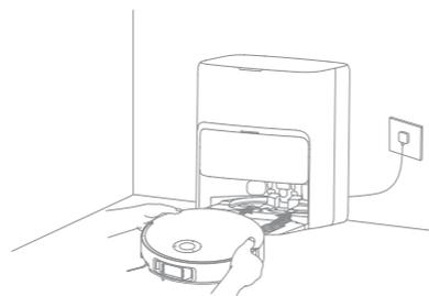
**Hinweis:** Es wird empfohlen, den Roboter vor der ersten Inbetriebnahme vollständig aufzuladen. Wenn sich der Roboter aufgrund eines leeren Akkus nicht einschalten lässt, verbinden Sie ihn zum Aufladen manuell mit der Basisstation.
