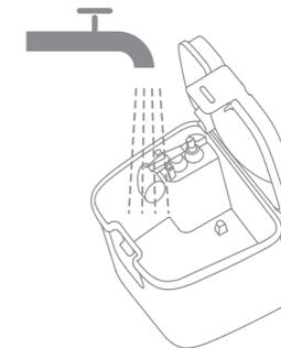
**Hinweis:** Die Schwimmerkugel im Schmutzwasserbehälter ist ein bewegliches Teil. Üben Sie beim Reinigen nicht zu viel Kraft aus, um sie nicht zu beschädigen.
