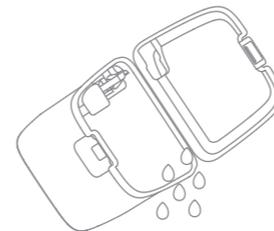
2. Wypłucz zbiornik na brudną wodę czystą wodą, wykorzystując odpowiednie narzędzie do czyszczenia ściany wewnętrznej zbiornika.
