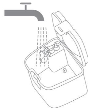
**Opmerking:** De vlotterbal in de vuilwatertank is een bewegend onderdeel. Gebruik niet teveel kracht tijdens het reinigen zodat deze niet beschadigt.
