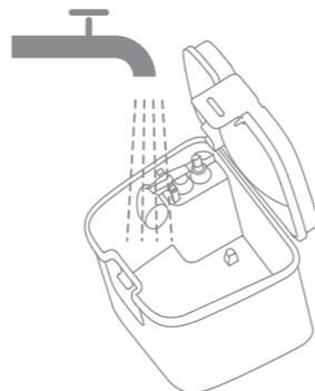
**Merk:** Flytekulen i skittenvanntanken er en bevegelig del. Ikke bruk for mye kraft når du rengjør den for å unngå skader.
