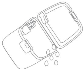
2. Enxague o depósito de água usada com água limpa e utilize a ferramenta de limpeza adequada para limpar a parede interna do depósito de água usada.
