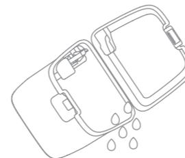
2. Spülen Sie den Schmutzwasserbehälter mit sauberem Wasser aus, und reinigen Sie die Innenwand des Schmutzwasserbehälters mit dem entsprechenden Reinigungswerkzeug.
