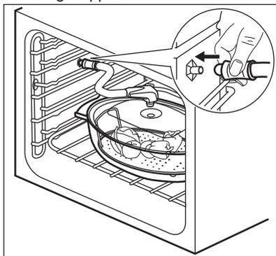
Se till att injektorröret inte viks eller att det vidrör något värmeelement högst upp i ugnen.
