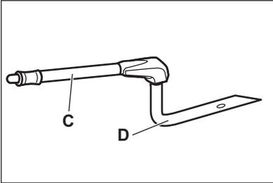
"C" är injektorröret för ångkokning, "D" är injektorn för direkt ångkokning.
