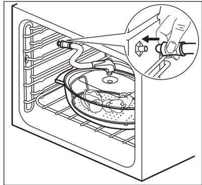
Pass på så du ikke klemmer injektorslangen eller lar den berøre et varmeelement på toppen av ovnen.
