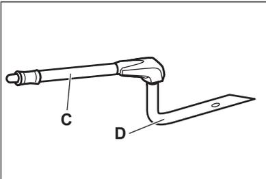
"C" on syöttöputki höyrykypsennykseen,
