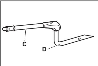
"C" er et dyserør til damptilberedning, "D" er dysen til direkte tilberedning med damp.
