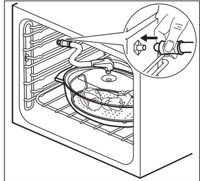
Varmista, ettei syöttöputki jää puristuksiin tai ettei se kosketa uunin yläosassa olevaan lämpövastukseen.
