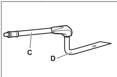
"C" er injektorslangen for dampkoking, "D" er injektoren for dampkoking.
