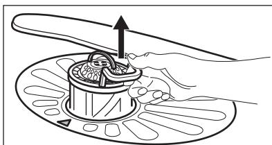
2. Verwijder de filter (**C**) uit de filter (**B**).
