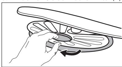
4. Reinigen Sie die Filter.
