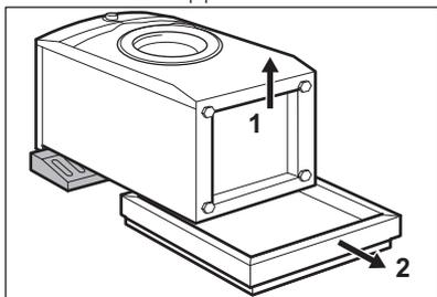
8. Nettoyez soigneusement et séchez le bas de l'appareil.
