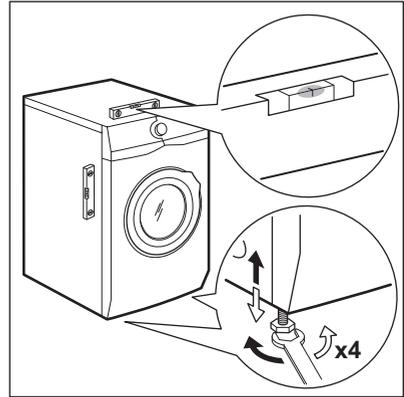
L'appareil doit être de niveau et stable.
