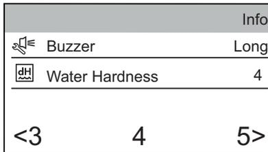
2. Faites défiler la liste des degrés vers la droite ou la gauche pour sélectionner le degré de dureté de l'eau souhaité.
