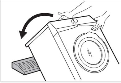
7. Retirez la protection en polystyrène en bas de l'appareil.
