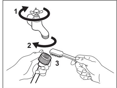
2. Retirez le tuyau d'arrivée de l'appareil en desserrant la bague de serrage.
