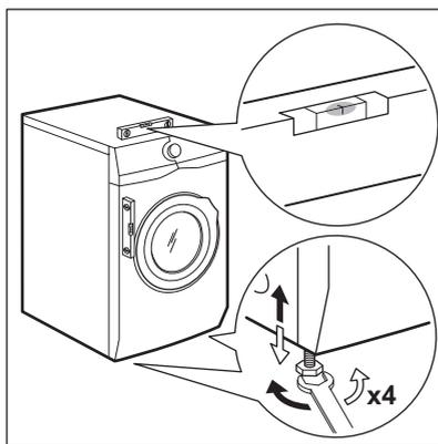
L'appareil doit être de niveau et stable.
