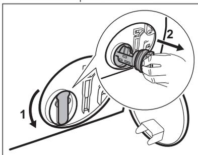
8. Si nécessaire, retirez les peluches et les débris de la cavité du filtre.
