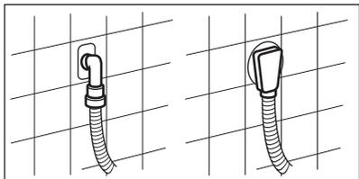
La longueur maximale du tuyau de vidange est de 400 cm. Contactez le service après-vente agréé pour obtenir d'autres longueurs de tuyaux de vidange et des rallonges.
