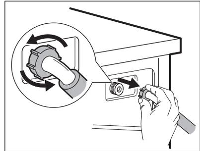
3. Utilisez une brosse à dents pour nettoyer le filtre de la valve situé à l'arrière de l'appareil.
