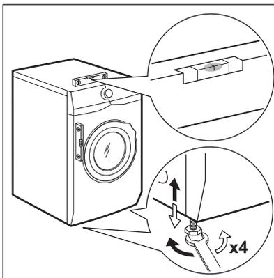
L'appareil doit être de niveau et stable.
