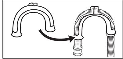
2. **Sur le bord d'un évier** : attachez le guide au robinet d'eau ou au mur.
