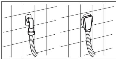
La longueur maximale du tuyau de vidange est de 400 cm. Contactez le service après-vente agréé pour obtenir d'autres longueurs de tuyaux de vidange et des rallonges.
