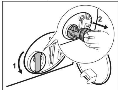
8. Si nécessaire, retirez les peluches et les débris de la cavité du filtre.
