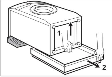
8. Nettoyez soigneusement et séchez le bas de l'appareil.
