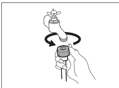
3. Reliez le tuyau à l'arrière de l'appareil. Ne pliez pas le tuyau d'arrivée d'eau vers le bas, mais positionnez-le vers la droite ou vers la gauche en fonction de votre robinet.
