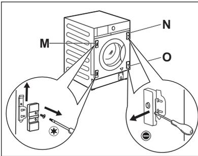
Si la porte du meuble doit être ouverte de gauche à droite, inversez la position des supports de charnière **M** avec la plaque magnétique **N** et la plaque inférieure **O**.
