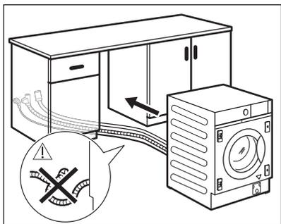
Avant de procéder à l'encastrement de l'appareil, approchez-le de la niche et mettez en position le tuyau d'arrivée, le tuyau de vidange et le câble d'alimentation secteur.
