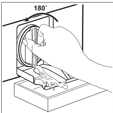
3. Tournez le filtre à 180 degrés dans le sens contraire des aiguilles d'une montre pour l'ouvrir sans le retirer. Laissez l'eau s'écouler.
