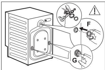
7. Bouchez les trous à l'aide des caches en plastique qui se trouvent dans le sac contenant le manuel d'utilisation. Placez le plus petit cache **F** sur le trou supérieur et les deux plus gros caches **G** sur les trous inférieurs.
