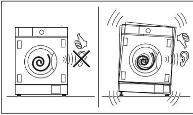
L'appareil doit être de niveau et stable.
