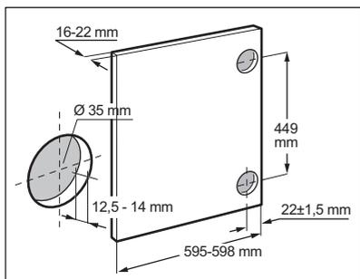
Fixez la position du trou inférieur en respectant les dimensions et les distances affichées dans le schéma (449 mm).
