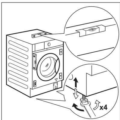
1. Installez l'appareil sur un sol plat et dur.
