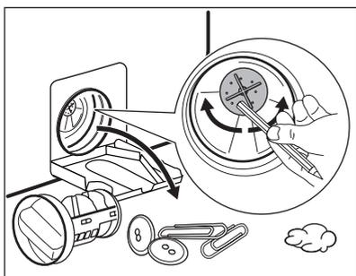
7. Si nécessaire, retirez les peluches et petits objets du compartiment du filtre.
