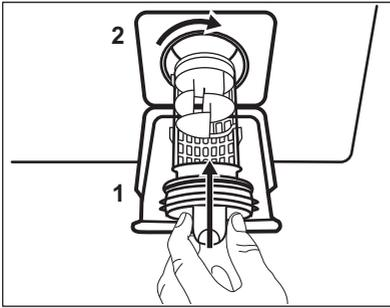
9. Remettez le filtre dans les encoches prévues en le faisant tourner dans le sens des aiguilles d'une montre. Assurez-vous de serrer correctement le filtre afin d'empêcher toute fuite.
