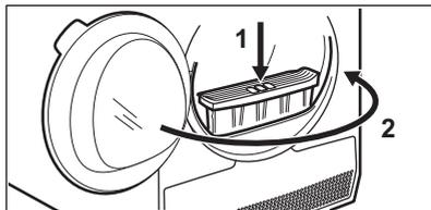
1) Si nécessaire, retirez les peluches du logement et du joint du filtre. Vous pouvez utiliser un aspirateur.
