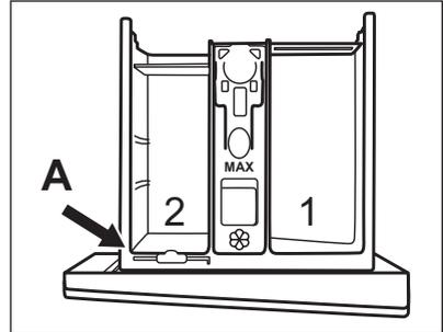
2. **Pour utiliser également de la lessive/des additifs liquides ou un agent blanchissant** : Sortez le séparateur de détergent de l'emplacement **A** et insérez-le dans l'emplacement **B**.
