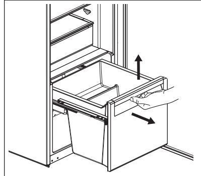
2. Repoussez les rails vers l'intérieur de l'appareil pour éviter de l'endommager lors de la fermeture de la porte.
