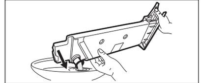
3. Remettez le raccord en plastique et le bac d'eau de condensation en position.
