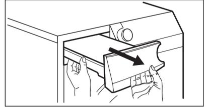
2. Sortez le raccord en plastique et vidangez le bac d'eau de condensation dans un évier ou un réceptacle équivalent.
