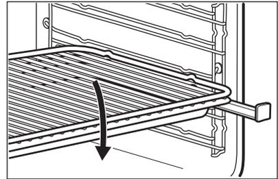
Posez la grille métallique sur la lèchefrite. Posez la grille métallique et le plat à rôtir sur les rails télescopiques.
