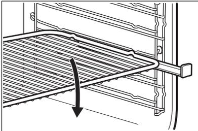
Placez la grille métallique sur les rails télescopiques de manière à ce que les tiges de guidage soient orientées vers le bas.
