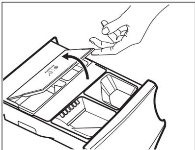
3. Versez doucement de la lessive liquide uniquement dans le réservoir de lessive AutoDose
