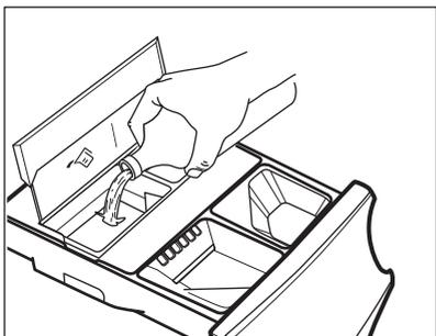
4. Versez doucement un assouplissant liquide uniquement dans le réservoir d'assouplissant AutoDose
