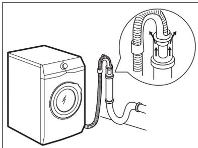
**i** L'extrémité du tuyau de vidange doit être ventilée en permanence, c'est-à-dire que le diamètre interne du conduit d'évacuation (minimum 38 mm - min. 1,5 po) doit être supérieur au diamètre externe du tuyau de vidange.
