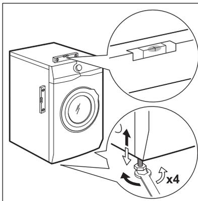
L'appareil doit être de niveau et stable.
