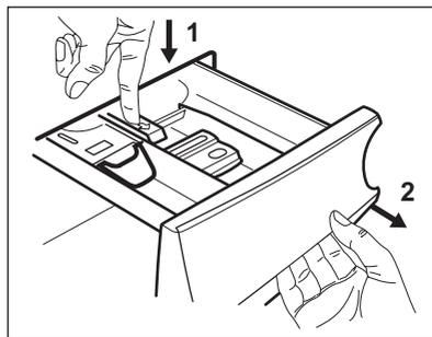
2. Retirez la partie supérieure du compartiment réservé à l'additif pour faciliter le lavage, et passez-le sous l'eau courante chaude pour éliminer toute trace d'accumulation de lessive. Après le nettoyage, remettez la partie supérieure en place.
