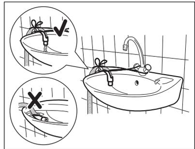
**i** Vérifiez que l'extrémité du tuyau de vidange n'est pas plongée dans l'eau. Il pourrait y avoir un reflux d'eau sale dans l'appareil.
