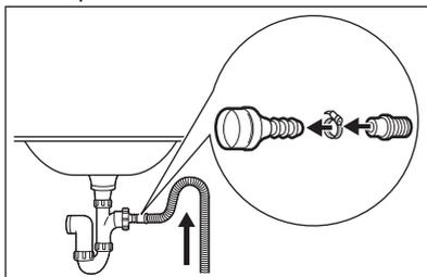
**i** Veillez à ce que le tuyau de vidange fasse une boucle afin d'éviter que des particules passent de l'évier à l'appareil.
