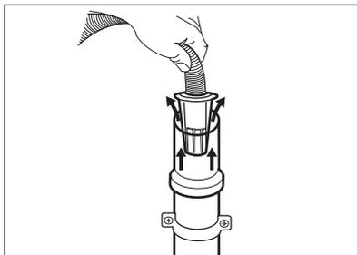
5. **Sans le guide de tuyau en plastique, vers un siphon d'évier -** Placez le tuyau de vidange dans le siphon et fixez-le avec une attache. Reportez-vous à l'illustration.
