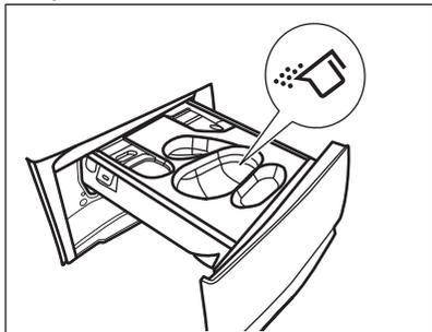
b) Versez la **lessive liquide** dans le même compartiment après avoir inséré le réservoir
