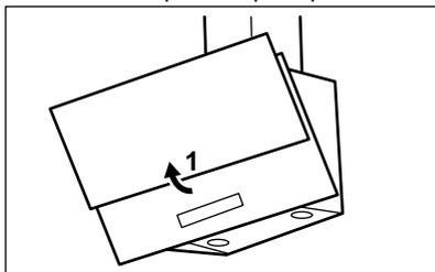
2. Premere l'impugnatura del clip di montaggio sul pannello del filtro sotto alla cappa (1).
