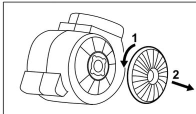
Aby z powrotem zmontować filtry, należy wykonać opisane czynności w odwrotnej kolejności.
