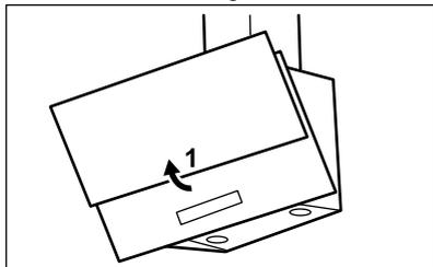
2. Tryk på grebet til monteringsclipsen på filterpanelet under emhætten (1).
