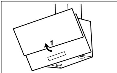
2. Drücken Sie den Griff der Befestigungsklammer an der Filterblende unterhalb der Dunstabzugshaube (1).
