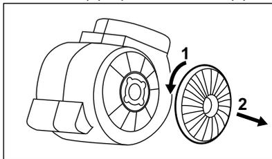
Při instalaci filtrů zpět proveďte stejný postup v opačném pořadí.
