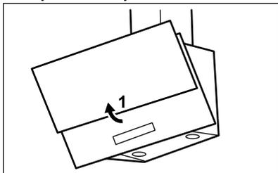
2. Stiskněte držadlo úchytky na panelu filtru pod odsavačem par (1).
