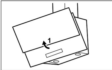
2. Натиснете дръжката на скобата за монтаж върху панела на филтъра под абсорбатора (1).
