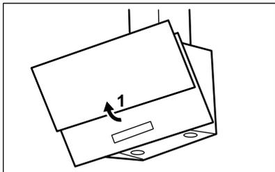
2. Stlačte rukoväť montážnej príchytky na paneli s filtrom na dolnej strane odsávača pár (1).
