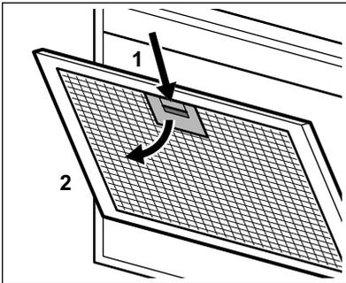
3. Incline ligeramente la parte delantera del filtro hacia abajo (2) y tire de él. Repita los dos primeros pasos para todos los filtros.
