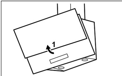
2. Premir o manípulo dos grampos de fixação no painel do filtro, por baixo do exaustor (1).
