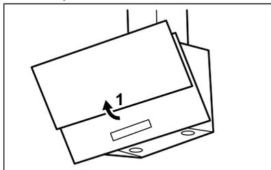
2. Притисните ручку стега за монтажу на панелу филтера испод аспиратора (1).
