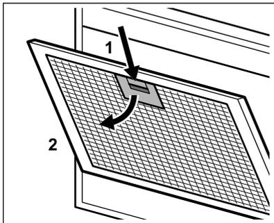
3. Немного наклоните переднюю часть фильтра вниз (2), а затем потяните.
