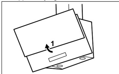
2. Tryck ner handtaget på monteringsklämman på filterpanelen under huven (1).
