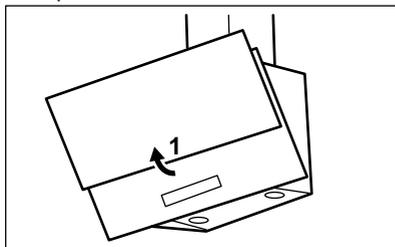
2. Druk op de handgreep van de montageclip op het filterpaneel onder de kap (1).
