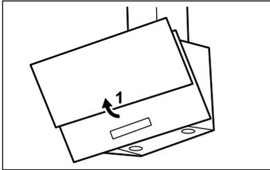
2. Davumbazının altında bulunan filtre panelindeki montaj klipsinin tutamağına basın (1).
