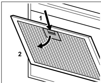
3. Kallutage filtri esiosa kergelt allapoole (2), seejärel tõmmake. Korrake kahte esimest toimingut kõigi filtrite puhul.
