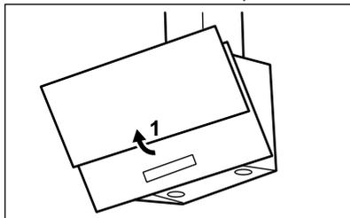
2. Trykk på håndtaket til monteringsklipsen på filterpanelet under ventilatoren (1).
