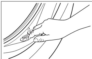
Si nécessaire, nettoyez-le en utilisant un agent nettoyant à l'ammoniaque et sans érafer la surface du joint.
