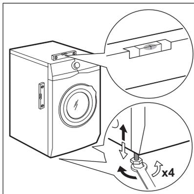
L'appareil doit être de niveau et stable.
