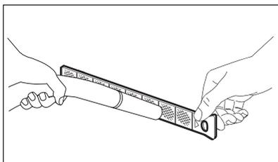
8. Réinsérez le filtre à air secondaire.
