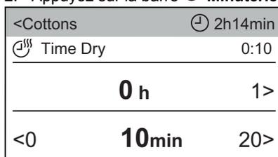
La durée minimale du séchage chronométrique est de 10 minutes.
