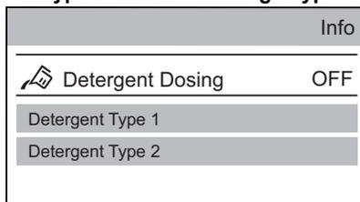
4. Faites défiler la barre du sous-menu vers la droite ou la gauche pour régler le dosage du détergent en ml, pour le faire correspondre au dosage moyen recommandé sur l'emballage du détergent.
