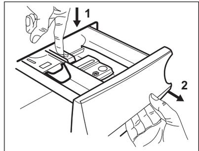
2. Pour un nettoyage plus facile, retirez également la partie supérieure du compartiment réservé à l'additif. Assurez-vous d'éliminer tous les résidus de lessive dans les parties supérieure et inférieure du logement. Utilisez une petite brosse pour nettoyer le logement.
