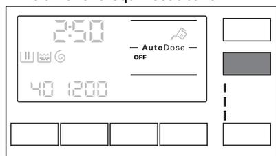
5. Pour régler le dosage de base, appuyez sur les touches correspondant aux réservoirs jusqu'à ce que le dosage de produit de lavage et deux flèches s'affichent en bas de l'écran. Appuyez sur la Température touche à plusieurs reprises pour diminuer le dosage et sur la Essorage touche pour l'augmenter : l'incrément minimum est de 1 ml (à chaque étape) ou
