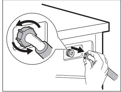
3. Utilisez une brosse à dents pour nettoyer le filtre de la vanne situé à l'arrière de l'appareil.
