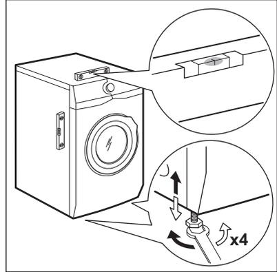
L'appareil doit être de niveau et stable.
