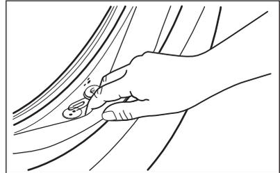
Si nécessaire, nettoyez-le en utilisant un agent nettoyant à l'ammoniaque et sans érafler la surface du joint.
