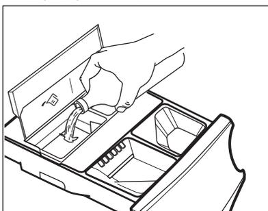
4. Versez doucement un assouplissant liquide uniquement dans le réservoir d'assouplissant AutoDose. Remplissez-le jusqu'au repère maximal **MAX**.
