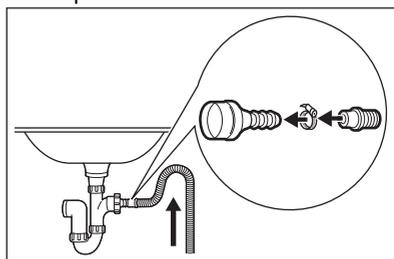
**i** Veillez à ce que le tuyau de vidange fasse une boucle afin d'éviter que des particules passent de l'évier à l'appareil.
