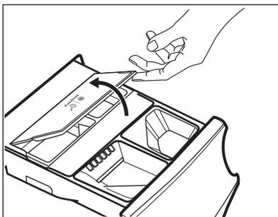
3. Versez doucement de la lessive liquide uniquement dans le réservoir de lessive AutoDose. Remplissez-le jusqu'au repère maximal **MAX**.
