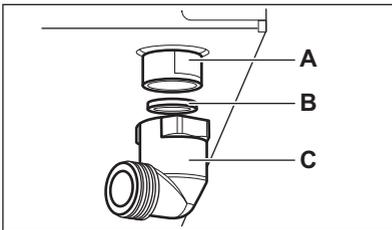
**A.** Extrémité du tuyau avec filetage
