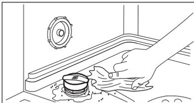
6. Rotiți capacul rezervorului pentru sare spre dreapta pentru a închide rezervorul.
