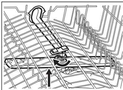
3. Spălați brațul stropitor sub un jet de apă. Folosiți un instrument subțire ascuțit, de ex. o scobitoare, pentru a îndepărta particulele de murdărie din orificii.
