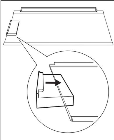
5. Insérez la clayette arrière en verre dans le compartiment réfrigérateur. Veillez à ne pas heurter le filtre lorsque vous insérez la clayette en verre.
