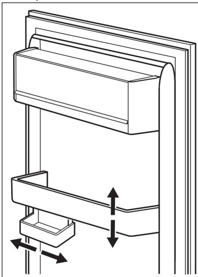
Ce modèle est équipé d'un compartiment de rangement variable qui peut être déplacé latéralement.
