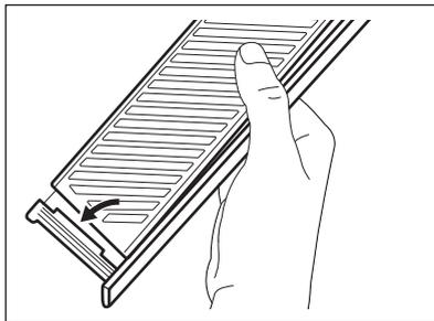
4. Repositionnez le dispositif de contrôle de l'humidité sur le bac.
