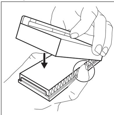
4. Retirez la clayette supérieure en verre du compartiment réfrigérateur. Faites glisser le boîtier en plastique avec le filtre à air sur le côté gauche de l'étagère en verre.
