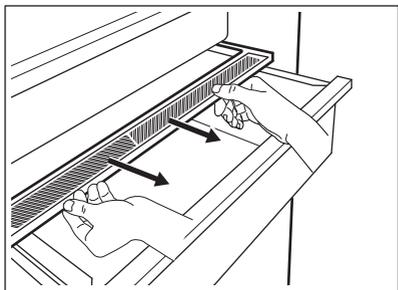
2. Si vous devez remplacer la membrane blanche de l'appareil, saisissez l'appareil au milieu et séparez la membrane du couvercle en tirant sur le couvercle.
