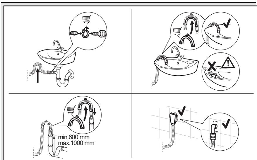
Veillez à ce que le tuyau de vidange fasse une boucle afin d'éviter que des particules passent de l'évier à l'appareil.
