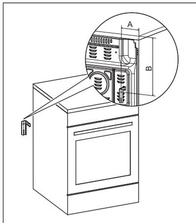
2. L'orifice se trouve à gauche, à l'arrière de l'appareil. Soulevez l'avant de l'appareil et placez-le au milieu de l'espace entre les placards. Si l'espace entre les placards est supérieur à la largeur de l'appareil, vous devez ajuster la mesure latérale pour centrer l'appareil.
