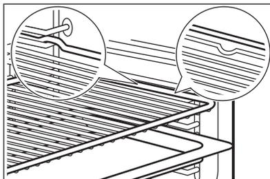
De petites indentations augmentent la sécurité et offrent une protection contre le renversement. Ce sont également des dispositifs anti-basculement. Le rebord de la grille empêche les ustensiles de cuisine de glisser hors de la grille.
