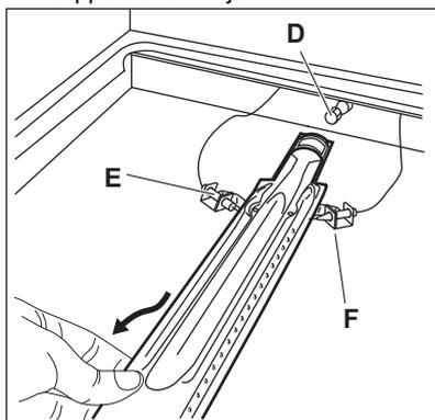
4. Déplacez-le lentement vers le côté gauche. Veillez à ce que la douille du brûleur reste sur l'embout du brûleur. Ne forcez pas sur le fil du connecteur de bougie F et sur le conducteur du thermocouple E.
