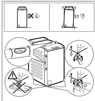
Positionnez correctement l'appareil pour éviter les vibrations, le bruit et les mouvements de l'appareil lorsqu'il fonctionne.
