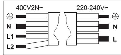
**Raccordement bi-phasé: 400 V2N~ (5x1,5 mm<sup>2</sup> or 4x2,5 mm<sup>2</sup>)**
