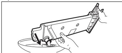
3. Remettez le raccord en plastique et le bac d'eau de condensation en position.
