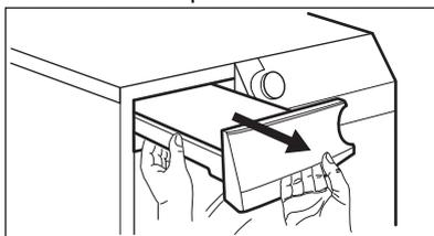
2. Sortez le raccord en plastique et vidangez le bac d'eau de condensation dans un évier ou un réceptacle équivalent.
