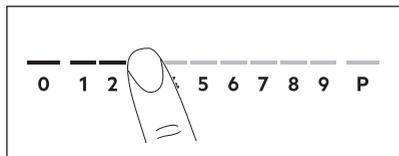
1. Appuyez sur le niveau de cuisson souhaité sur le bandeau de sélection. Les voyants situés au-dessus du bandeau de sélection apparaissent jusqu'au niveau de cuisson sélectionné.
