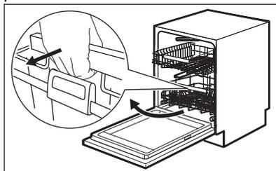
Le panier est automatiquement verrouillé au niveau supérieur.
