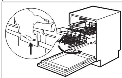
Une fois le panier déverrouillé, poussez-le vers le bas. Le mécanisme revient à sa position par défaut au niveau inférieur.
