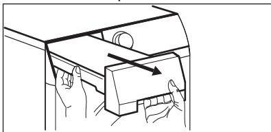
2. Retirez le raccord en plastique et vidangez le bac d'eau de condensation dans une cuvette ou un récipient équivalent.
