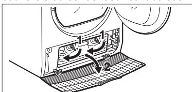
4. Si nécessaire, retirez les peluches sur le condenseur et dans son compartiment. Vous pouvez utiliser un aspirateur avec une brosse.
