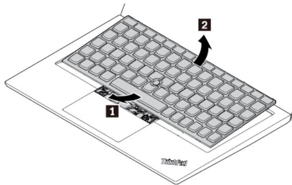
9. Placez le clavier sur le repose-mains, comme indiqué. Ôtez la protection en plastique et détachez les connecteurs. Retirez ensuite le clavier.
