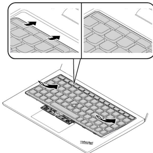
3. Faites glisser le clavier dans le sens indiqué par les flèches. Assurez-vous que les loquets sont fixés sous le cadre du clavier.
