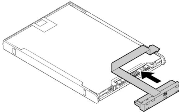
3. Insérez la nouvelle unité de stockage **1**, puis faites-la pivoter vers le bas **2**. Vérifiez que la nouvelle unité de stockage est bien installée.
