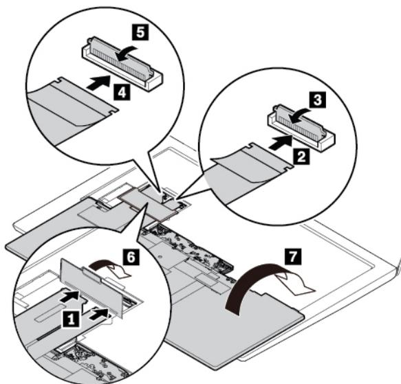
2. Insérez le clavier dans le panneau du clavier comme indiqué. Assurez-vous que le bord avant du clavier (le bord du côté de l'écran de l'ordinateur) est sous le cadre du panneau du clavier.
