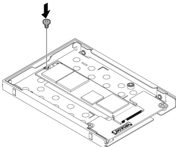
3. Installez le cache de protection **1** puis installez les vis pour le fixer **2**.
