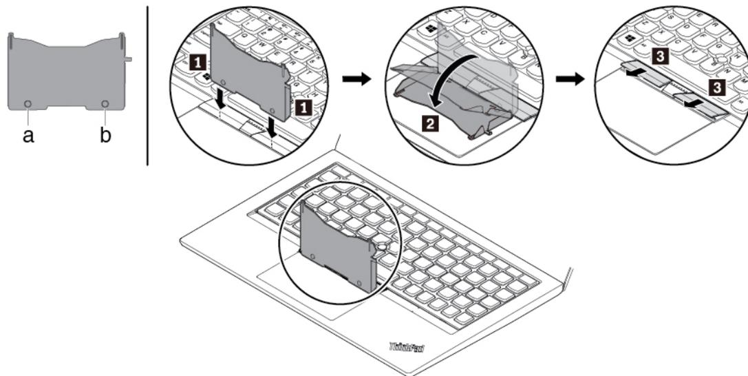
5. Desserrez les vis de fixation du clavier.
