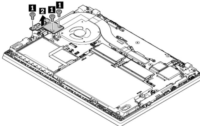
6. Installez la nouvelle carte USB/audio **1**, puis réinstallez les vis de fixation de la carte USB/audio **2**.
