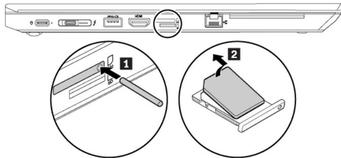
3. Installez une nouvelle carte nano-SIM dans le plateau, les contacts métalliques vers le bas **1**. Insérez le plateau dans le logement pour carte nano-SIM jusqu'à ce que vous entendiez un clic **2**. Assurez-vous que la nouvelle carte nano-SIM est correctement placée et orientée.
