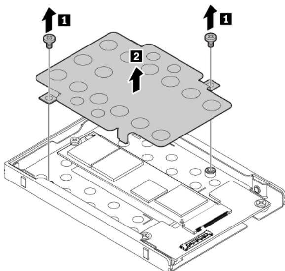
9. Retirez la vis de fixation du disque SSD M.2. L'unité SSD M.2 est dégagée de sa position et pivote vers le haut.
