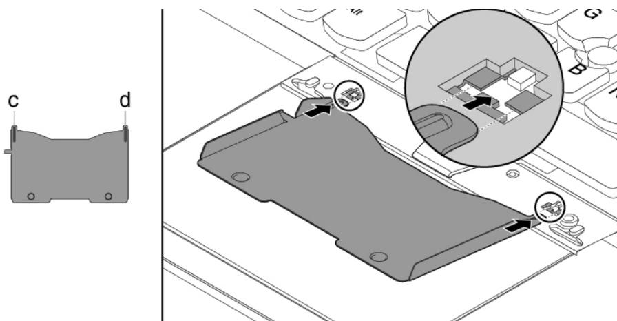
7. Faites pivoter l'outil dans la direction indiquée pour libérer le clavier **1**. Poussez le clavier dans la direction indiquée par les flèches **2** afin de débloquer les loquets du panneau du clavier.
