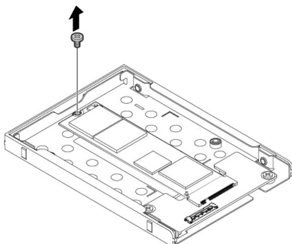
10. Retirez doucement le disque SSD M.2 pour la retirer du logement M.2.
