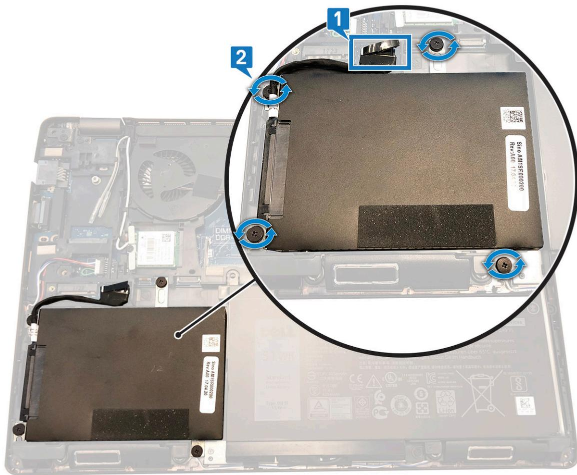
c) Soulevez l'assemblage de disque dur pour le retirer de l'ordinateur.
