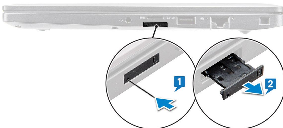
**REMARQUE :** Pour les ordinateurs Latitude 7280, la carte mémoire doit être retirée avant de remplacer tout composant du système. L'oubli du retrait de la carte mémoire avant le démontage d'autres composants risque d'endommager le système.
