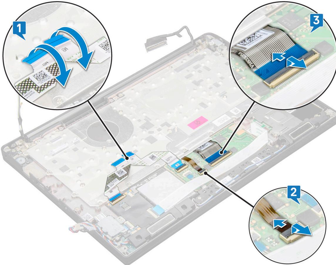
12. Pour retirer l'assemblage du clavier :
