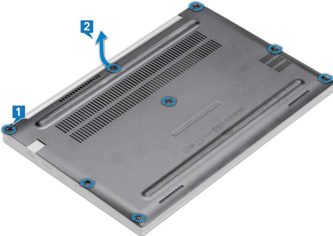
**PRÉCAUTION :** Faites preuve de prudence lorsque vous deserrez les vis. Inclinez le tournevis pour le placer sur la tête de vis (coins avant sur le cache de fond de l'ordinateur portable) pour éviter de décaper la tête de vis.
