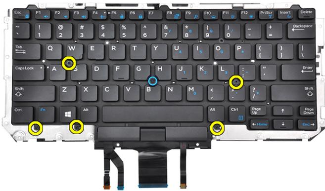
3. Installez l'assemblage du clavier.
