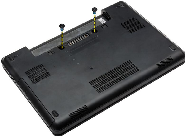
4. Retirez les vis de fixation du clavier [1] puis enlever le clavier de l'ordinateur [2],[3].
