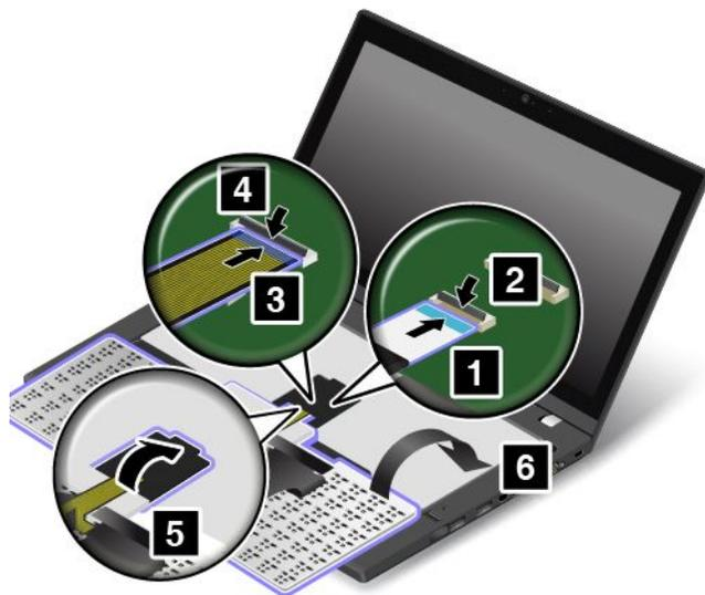
2. Insérez le clavier dans le panneau du clavier comme indiqué. Assurez-vous que le bord avant du clavier (le bord du côté de l'écran) est sous le cadre du panneau du clavier.
