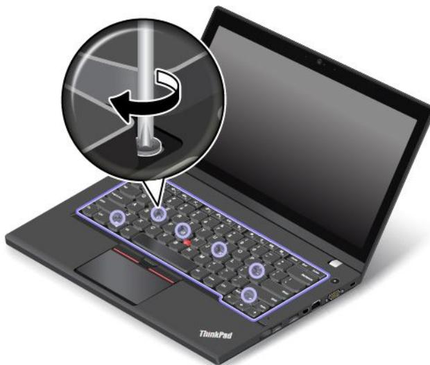
5. Faites glisser le cadre du clavier de 2,5 mm vers l'arrière à l'aide de l'extrémité plate de l'outil spécial clavier de façon à placer les loquets du cadre du clavier sous le panneau du clavier.
