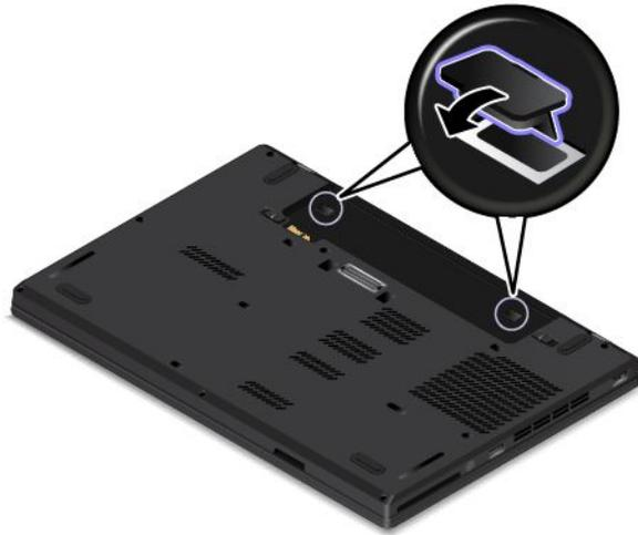
8. Réinstallez la batterie. Voir « Remplacement de la batterie » à la page 133.
