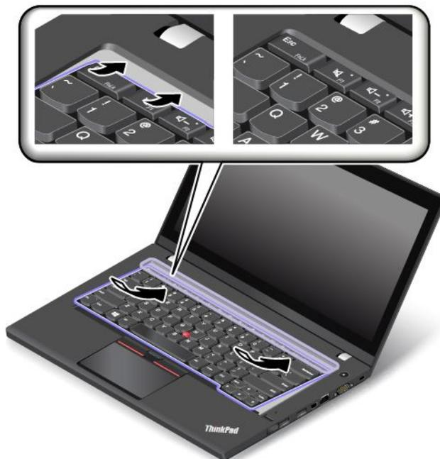
3. Assurez-vous que les têtes de vis sont entièrement exposées. Si ce n'est pas le cas, faites apparaître les têtes de vis en faisant glisser le cadre du clavier vers l'avant à l'aide de l'extrémité plate de l'outil spécial clavier.
