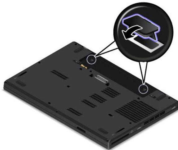
13. Réinstallez la batterie. Voir « Remplacement de la batterie » à la page 133.
