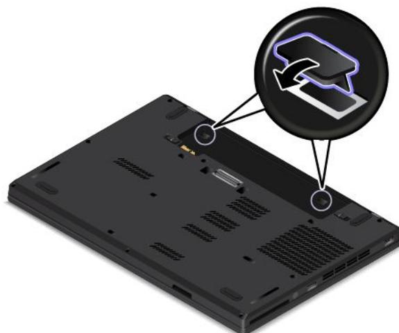
11. Réinstallez la batterie. Voir « Remplacement de la batterie » à la page 133.
