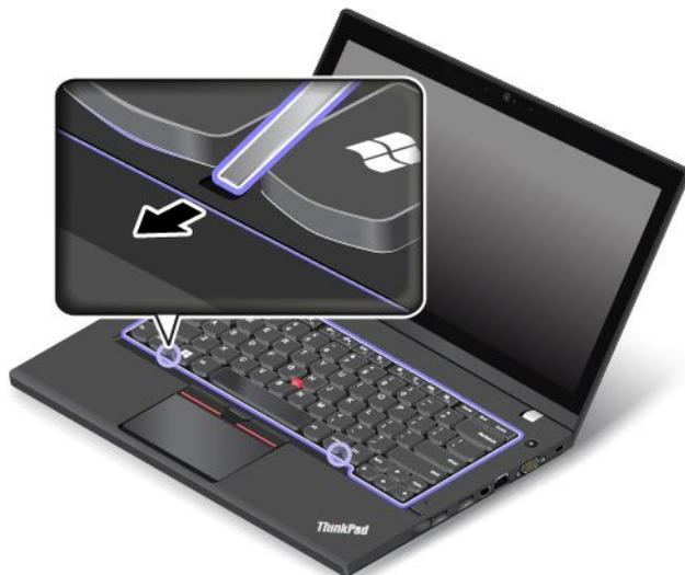
6. Insérez l'extrémité plate de l'outil spécial clavier dans les bords du clavier comme illustré, de façon à pousser le cadre du clavier vers l'arrière. Assurez-vous qu'il ne reste pas d'espace entre le cadre du clavier et le panneau du clavier.
