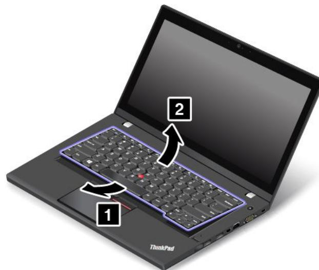
9. Placez le clavier sur le repose-mains et débranchez les connecteurs. Retirez ensuite le clavier.
