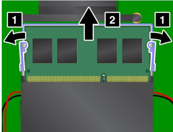
9. Placez le côté avec encoche du nouveau module de mémoire sur le côté du bord de contact de l'emplacement de mémoire. Insérez le module de mémoire **1** dans l'emplacement en l'inclinant d'environ 20 degrés. Faites pivoter le module de mémoire vers le bas jusqu'à ce qu'il s'enclenche **2**. Vérifiez que le module de mémoire est bien installé et ne peut être déplacé facilement. Relâchez ensuite la main maintenant le film.
