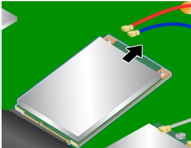
11. Insérez le bord de contact de la nouvelle carte dans le contact femelle correspondant **1**. Faites pivoter la nouvelle carte vers le bas **2**.
