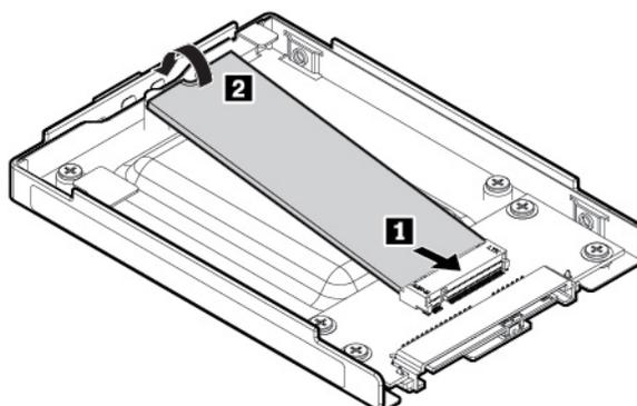
2. Installez ensuite la vis de fixation de la nouvelle unité SSD M.2.
