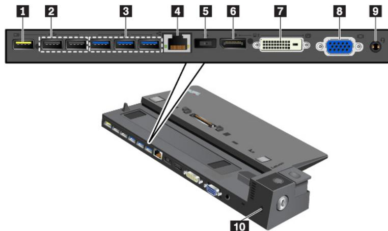
**1 Connecteur Always On USB 2.0** : permet de brancher les périphériques USB compatibles ou de charger certains appareils numériques mobiles et smartphones.
