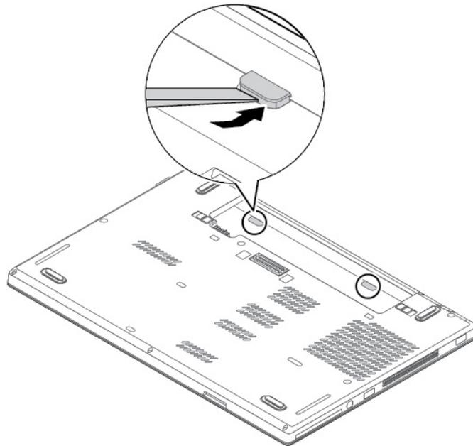
6. Desserrez les vis **1** qui maintiennent en place le cache de la base. Soulevez les loquets **2** comme indiqué, puis retirez le cache de la base dans la direction indiquée par la flèche **3**.
