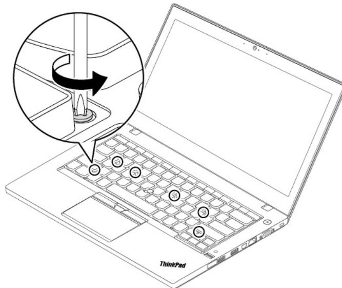
7. Faites pivoter légèrement le clavier vers le haut jusqu'à voir les connecteurs situés sous le clavier. Retournez ensuite le clavier.
