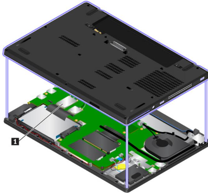
**Remarque :** Pour le module sans fil installable par l'utilisateur, assurez-vous que vous utilisez uniquement un module sans fil agréé par Lenovo spécifiquement testé pour ce modèle d'ordinateur. Dans le cas contraire, l'ordinateur émettra des signaux sonores de code d'erreur au démarrage.
