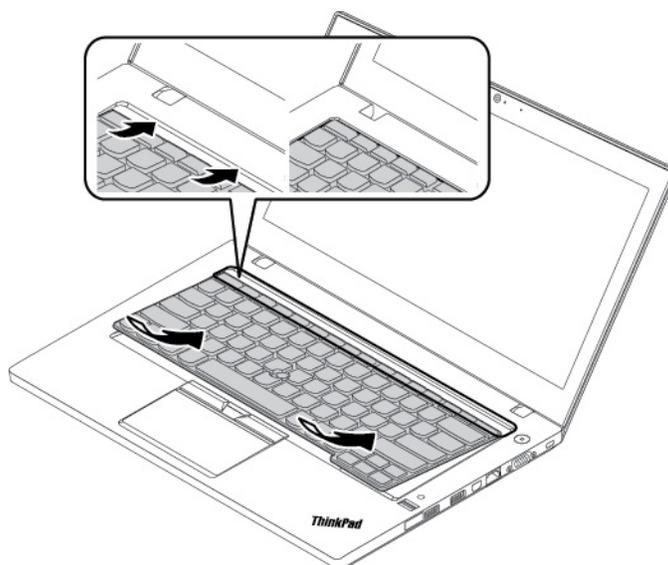
3. Assurez-vous que les têtes de vis sont entièrement exposées. Sinon, faites apparaître les têtes de vis en faisant glisser le cadre du clavier vers l'avant.
