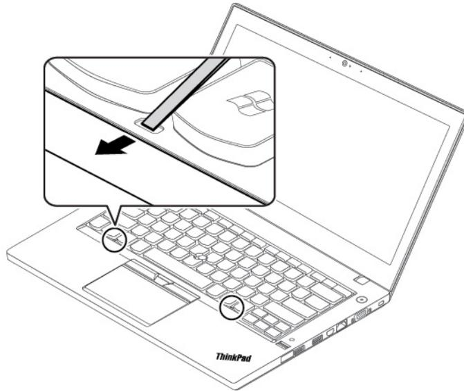
6. Poussez le cadre du clavier vers l'arrière. Assurez-vous qu'il ne reste pas d'espace entre le cadre du clavier et le panneau du clavier.
