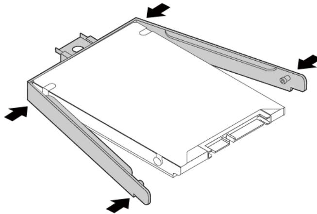
2. Insérez la nouvelle l'unité de disque dur et son support **1**, puis faites-la pivoter vers le bas **2**. Vérifiez que la nouvelle l'unité de disque dur est bien installée.
