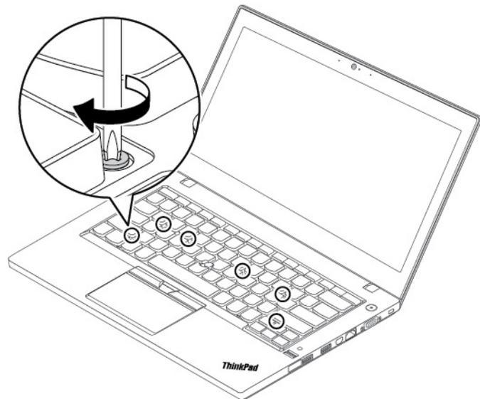
5. Faites glisser le cadre du clavier vers l'arrière de 2,5 mm. Assurez-vous que les loquets du clavier du cadre du clavier sont masquées sous le panneau du clavier.
