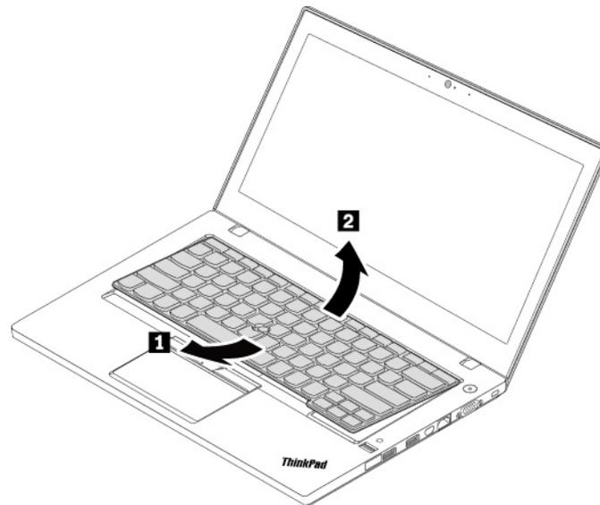
8. Placez le clavier sur le repose-mains et débranchez les connecteurs. Retirez ensuite le clavier.
