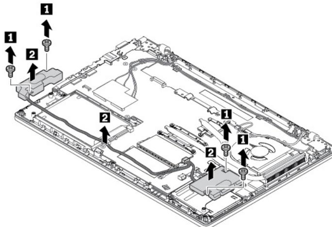
7. Installez le nouvel assemblage de haut-parleurs puis serrez les vis de fixation pour le maintenir en place.
