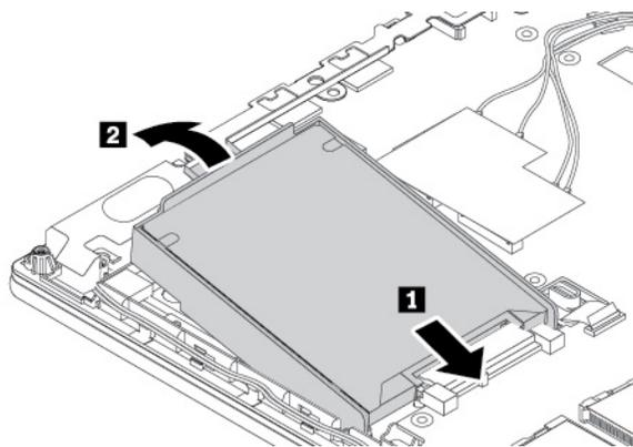
3. Installez la vis de fixation de la nouvelle l'unité de disque dur.
