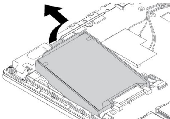
7. Retirez les vis de fixation du cache de protection **1** et retirez le cache **2**.
