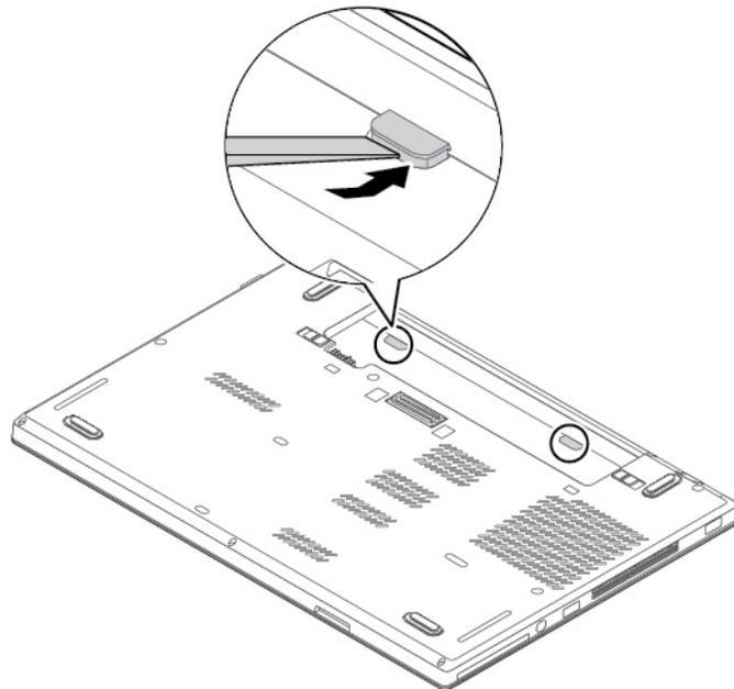
5. Faites apparaître les têtes de vis en dessous du cadre du clavier en faisant glisser le clavier vers l'avant de 2,5 mm.
