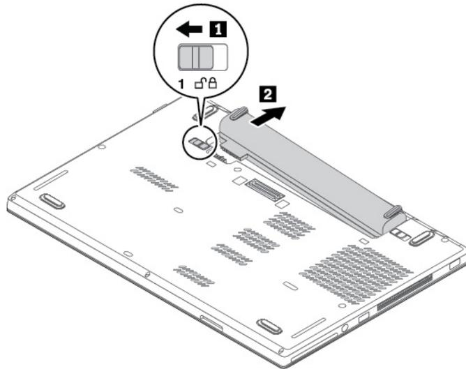
4. Faites glisser l'autre loquet de la batterie en position déverrouillée **1**. Retirez la batterie du cache de la base sur la droite, comme indiqué par la flèche **2**.
