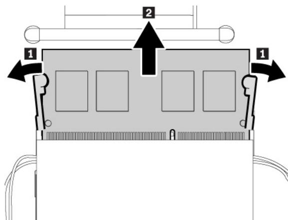
7. Insérez le nouveau module de mémoire dans l'emplacement de mémoire en l'inclinant d'environ 20 degrés **1**. Faites pivoter le module de mémoire vers le bas jusqu'à ce qu'il s'enclenche **2**. Vérifiez que le module de mémoire est bien installé dans l'emplacement de mémoire et ne peut être déplacé facilement.
