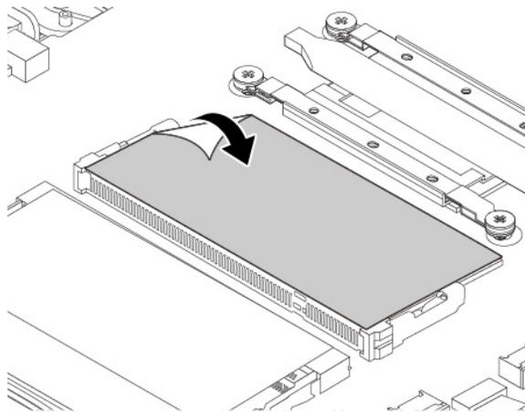
6. Ouvrez simultanément les loquets situés sur les deux côtés de l'emplacement de mémoire **1**, puis retirez le module de mémoire **2**.
