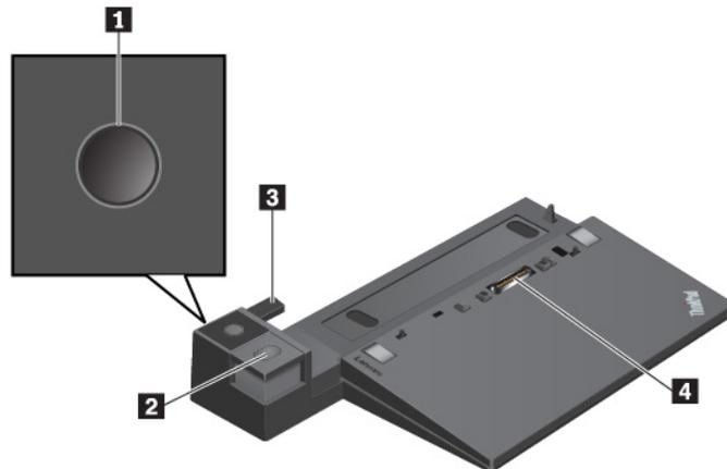
**1 Interrupteur d'alimentation** : appuyez sur l'interrupteur d'alimentation pour allumer ou éteindre l'ordinateur.
