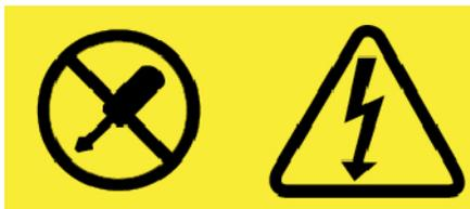
Les composants portant cette étiquette contiennent une tension, un courant électrique et des niveaux d'énergie dangereux. Aucune pièce de ces composants n'est réparable. Si vous pensez qu'un de ces composants présente un incident, contactez un technicien de maintenance.
