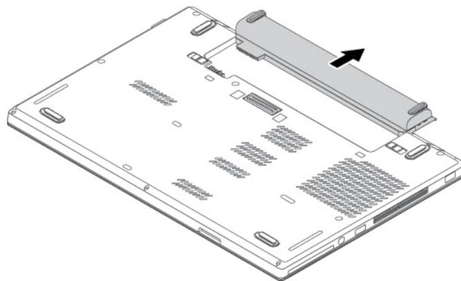
6. Insérez une nouvelle batterie jusqu'à ce qu'elle s'enclenche. Assurez-vous que les loquets de la batterie sont en position verrouillée.
