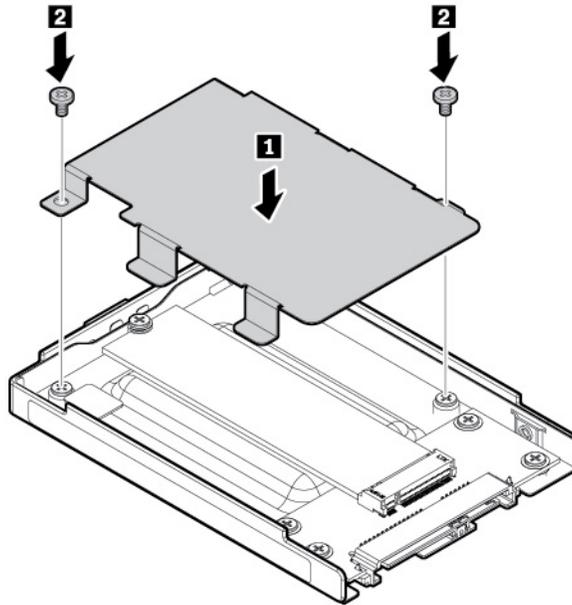
4. Insérez l'adaptateur **1**, puis faites-le pivoter vers le bas **2**. Assurez-vous que l'adaptateur de disque SSD M.2 est bien en place.
