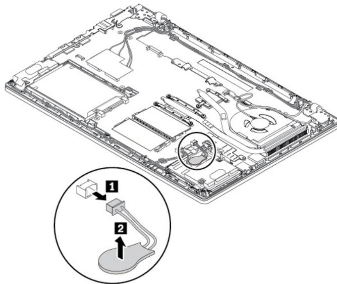
6. Installez la nouvelle batterie à pile cellulaire **1** et branchez le connecteur **2**.
