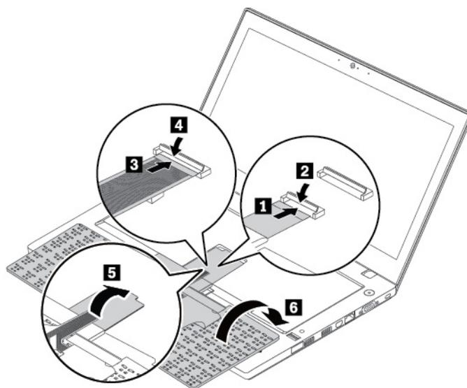
2. Insérez le clavier dans le panneau du clavier. Assurez-vous que le bord supérieur du clavier (le bord du côté de l'écran) est sous le cadre du panneau du clavier.
