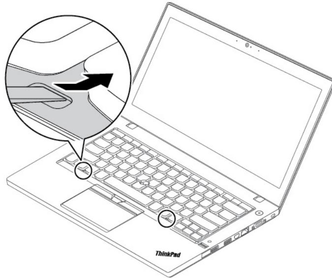
4. Resserrez les vis de fixation du clavier.
